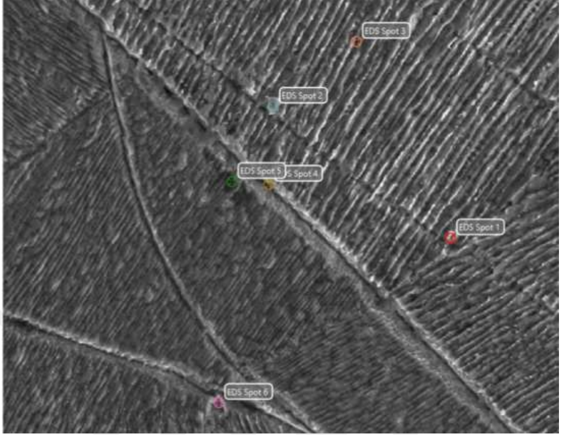
Şekil 6.7: Laser Işını ile Kaynak Edilmiş Numune1'in ITAB'daki EDS Analiz Noktaları; Kaynak Parametreleri: Laser Gücü: 2100 W, Frekans: 10 Hz, Işın Genişliği 4mm, Gaz Debisi: 135 Bar
