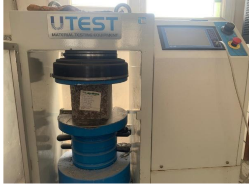
Őekil 16. Beton test presi
