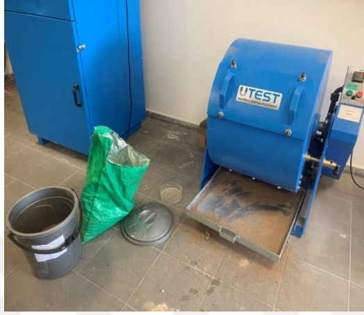
Şekil 17. Los Angeles aşındırma cihazı
