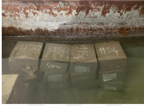
Őekil 19. Beton kr havuzu
