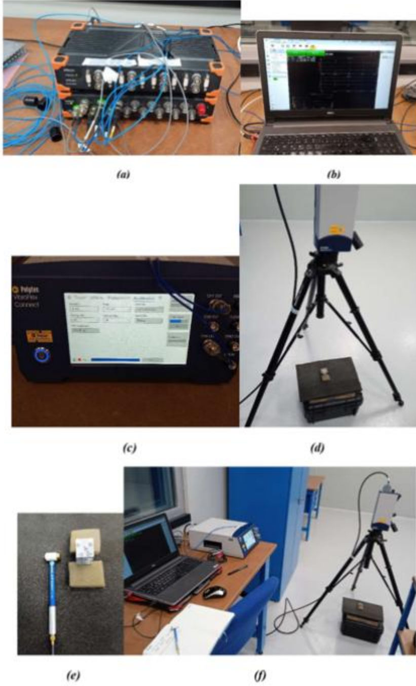
Şekil 3.4 : Titreşim testlerinde kullanılan ekipmanlar: (a) ve (b) Veri Toplama Sistemi); (c) ve (d) Lazer Hız Ölçer (Vibrometer); (e) Darbe Çekici; (f) Deney düzeneği.
