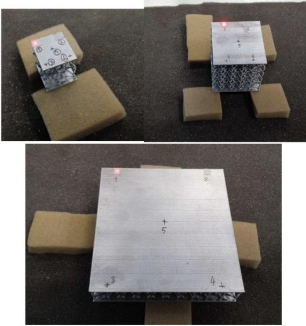
Şekil 3.6 : Serbest sınır koşullarını temsil etmek için 4 noktadan yumuşak sünger üzerine oturtulmuş numune örnekleri.
