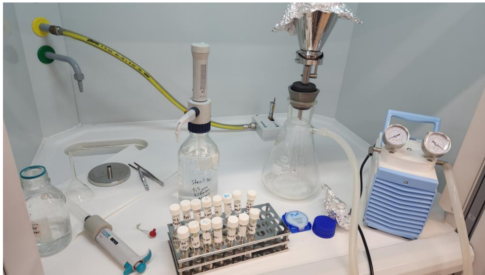
Şekil 3.13 Kabin İçinde Gerçekleştirilen Çeşitli Por Açıklığına Sahip (1 µm Yakın Üst ve Altı) Filtreler ile Filtreleme İşlemlerinden Bir Görünüm.
