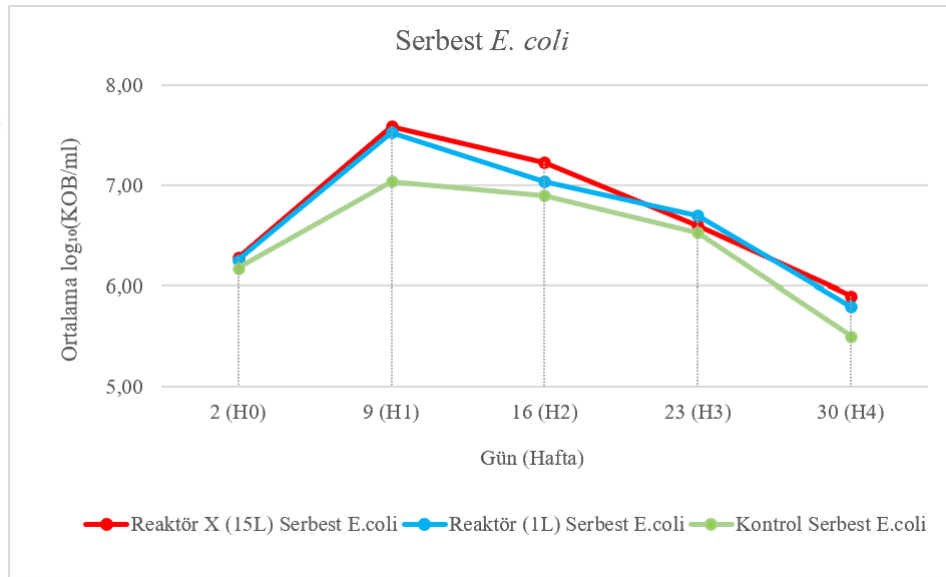
Şekil 4.1 Reaktör (1L) ve Reaktör X (15L) Sentetik Atıksu Sistemleri ve Kontrol Grubu (1L) Dört Haftalık Süreç Boyunca Ortalama Serbest E. coli Gelişim/Değişim Düzeylerinin Karşılaştırılması (Tablo 4.1).
