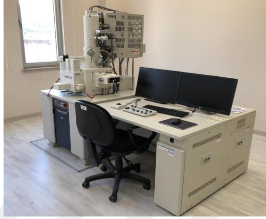
Şekil 3.17 Hitachi Regulus 8230 Marka/Model Taramalı Elektron Mikroskobu (FE-SEM; ARUM, 2023)
