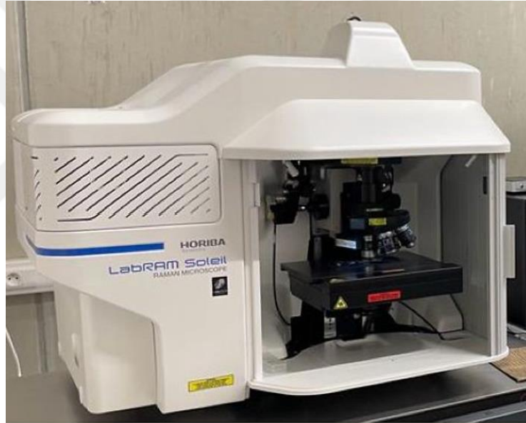
Şekil 3.23 Horiba LabRAM Soleil Raman Mikro Spektroskopi Cihazı (ST Instruments, 2024)
