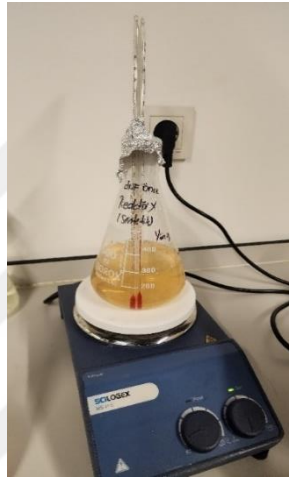
Şekil 3.19 Protokol-1 0.05M Fe (II) Solüsyonu + %30 H 2 O 2 Eklenen Numunenin 60°C'ye Isıtılması.
