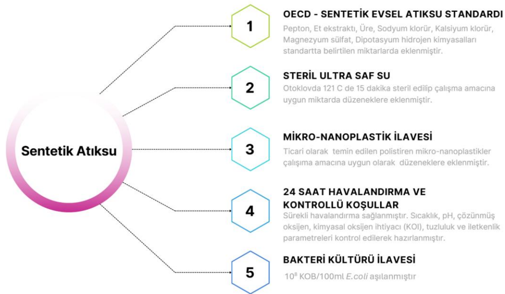
Şekil 3.2 Sentetik Evsel Atıksu Hazırlama Aşamaları
