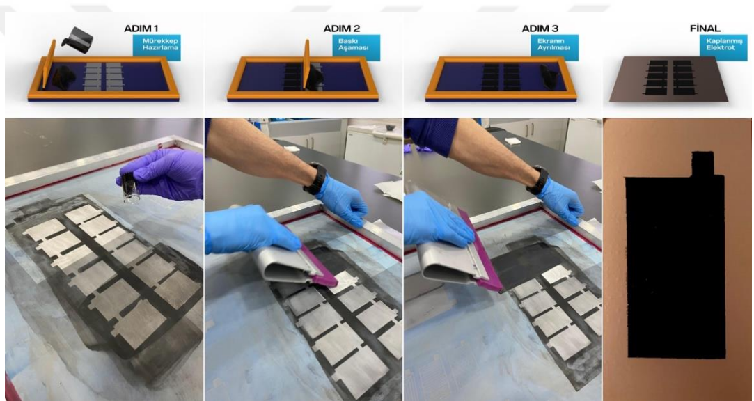
Şekil 4.1. Ekran baskı yönteminin uygulama gösterimi ve fiziksel uygulaması
