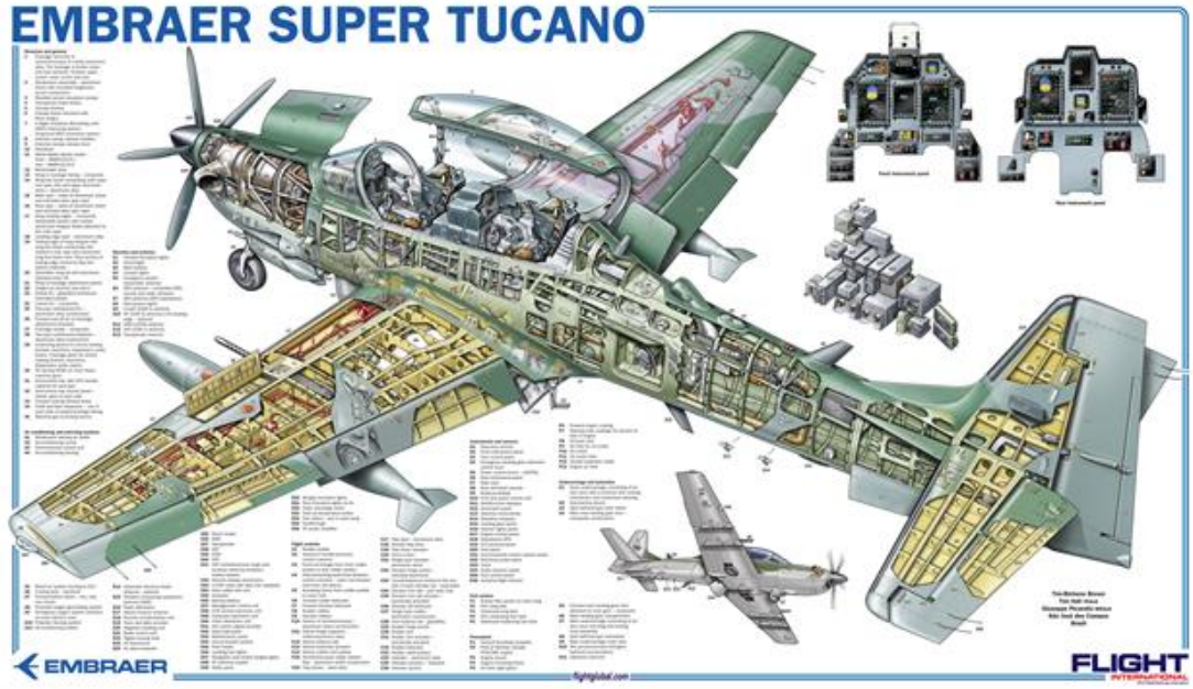
Şekil 1.11 : Super-Tucano iç yapısal tasarımı [9].
