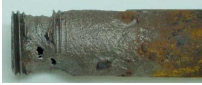
Şekil 1.8. Aralık korozyonuna uğramış metal boru (URL-2, 2025)
