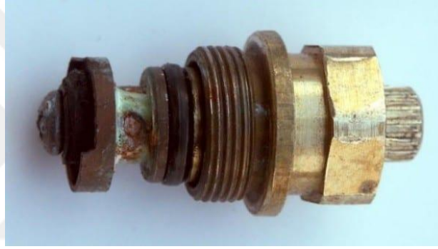
Şekil 1.7. Seçimli korozyona uğramış pirinç valf (URL-2, 2025)
