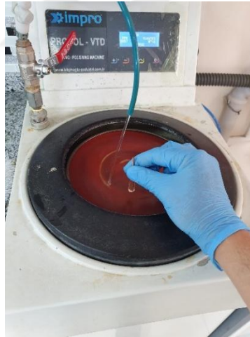
Şekil 3.2. Bakır elektrotları farklı büyüklükteki zımpara kâğıtları ile parlatma işlemi
