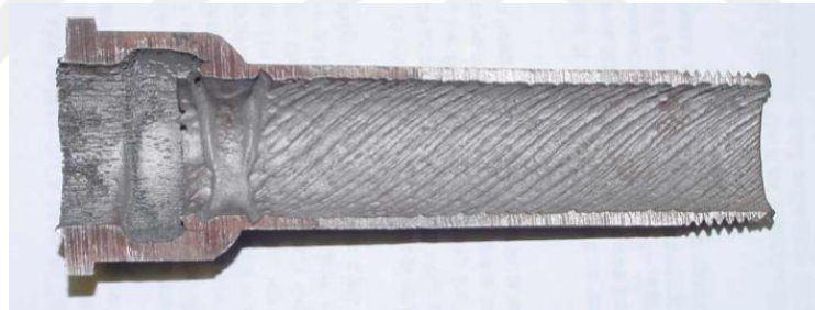
Şekil 1.10 Erozyon korozyonuna uğramış metal boru kesiti (URL-2, 2025)
