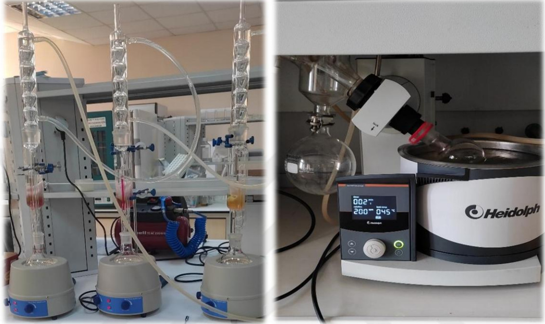
Şekil 3.4: Soxhlet cihazında ekstraksiyon işlemi ve Rotary Evaporatörde evaporasyon.
