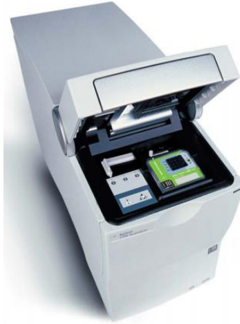
Şekil 2.4 Bioanayzer (Agilent 2100) cihazı ve RNA RIN değerlerinin kontrol edilmesinde kullanılan RNA 6000 Pico çip.
