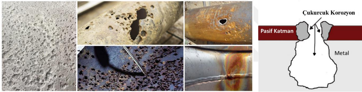
Şekil 6. Çukurcuk korozyonu ve şematik gösterimi (Anonymous, 2022)
