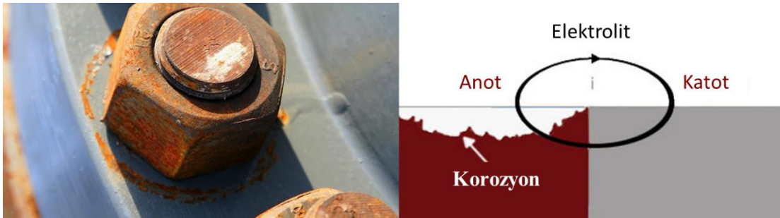
Şekil 5. Galvanik korozyon ve şematik gösterimi (Anonymous, 2024)
