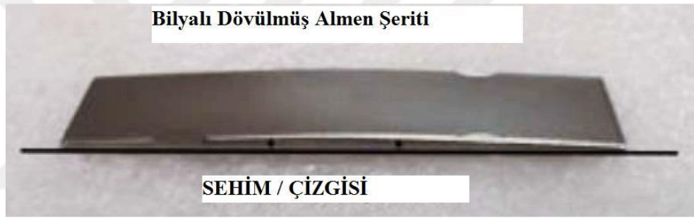
Şekil 28. Almen testi sonrasında şeritte meydana gelen deformasyon (Brooks, 2016)
