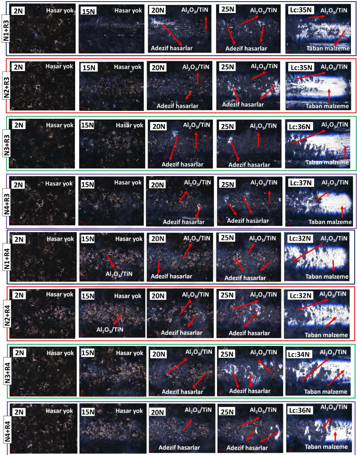
Şekil87. Bilyeli dövme işlemi uygulanmış ve daha sonra PEO/TiN (R1-R4) dubleks kaplanmış numunelerin scratch (Çizik) test sonuçları (Devamı)
