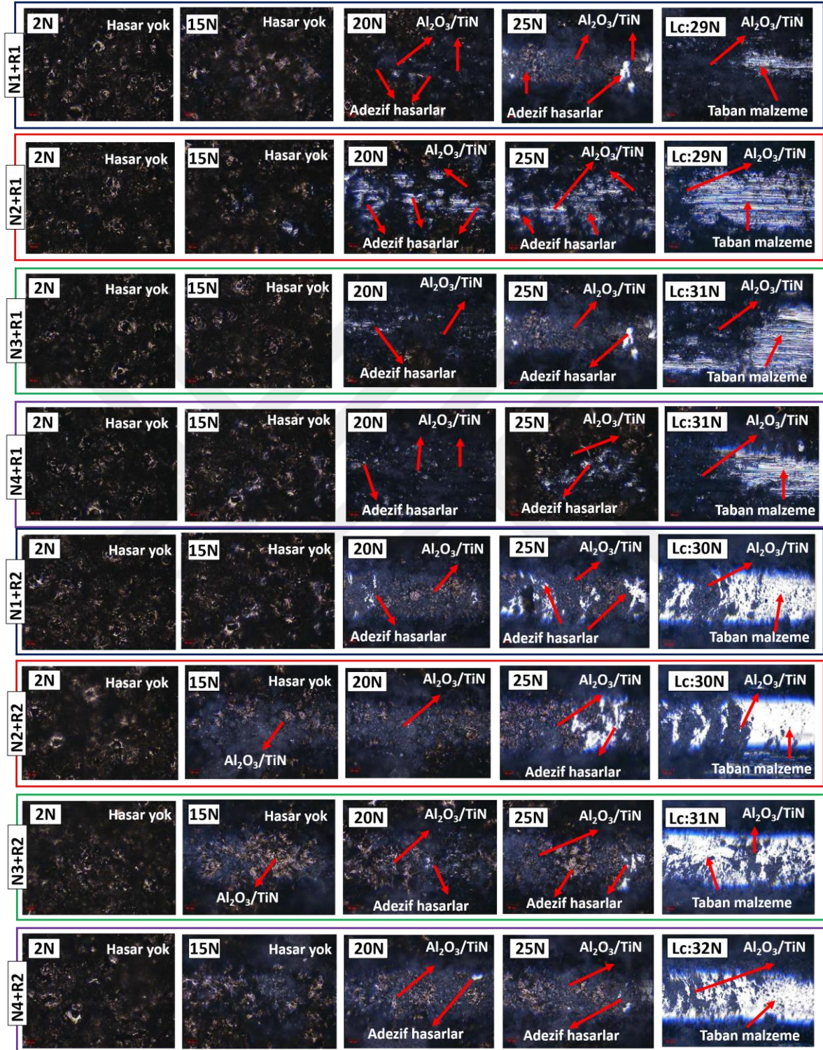
Şekil 87. Bilyeli dövme işlemi uygulanmış ve daha sonra PEO/TiN (R1-R4) dubleks kaplanmış numunelerin scratch (Çizik) test sonuçları
