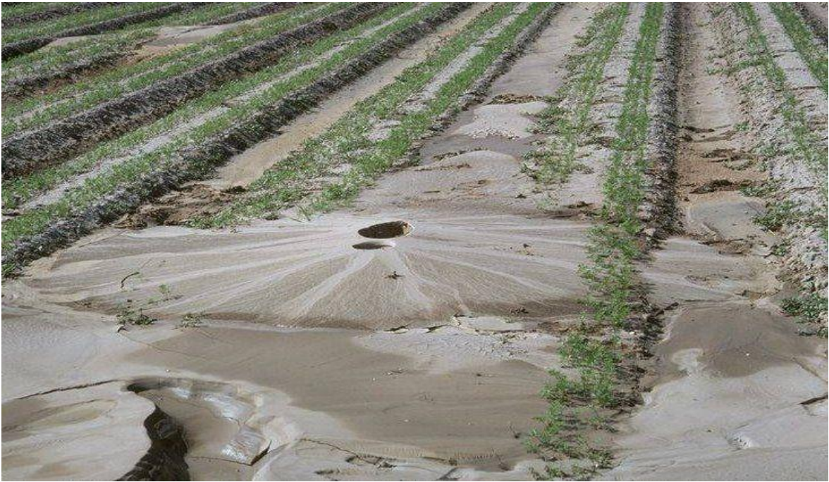
Şekil 2.5. El Centro depremde döngüsel mobilite tipi sıvılaşma (Hwy, 1979)
