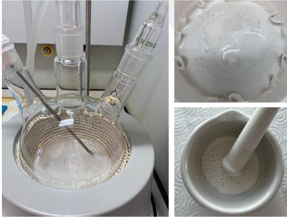
Şekil 3.1. PM katkılı HA sentezine ait fotoğraflar: (a) Üç boyunlu reaktör içerisinde 70 °C'de karıştırılan solüsyonların reaksiyonu, (b) filtrasyon ve yıkama işlemine ait görüntü, (c) reaksiyon tamamlandıktan sonra gerçekleştirilen filtrasyon ve yıkama işlemleri sonrası elde edilip 100 °C'de 24 saat kurutulmuş örnek havanda öğütülürken görüntüsü
