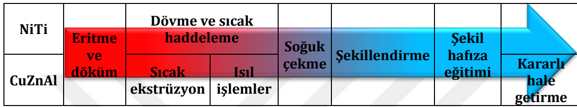
Şekil 2.15. NiTi ve CuZnAl alaşımlarının üretim işlem adımları [54].
