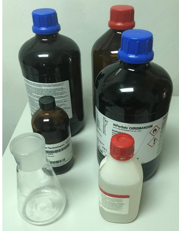
Şekil 3.7. 2.5 gr ( \text{FeCl}_3 \cdot 6\text{H}_2\text{O} )-48 ml \text{CH}_3\text{OH} ve 10ml HCl dağlama çözeltisi.
