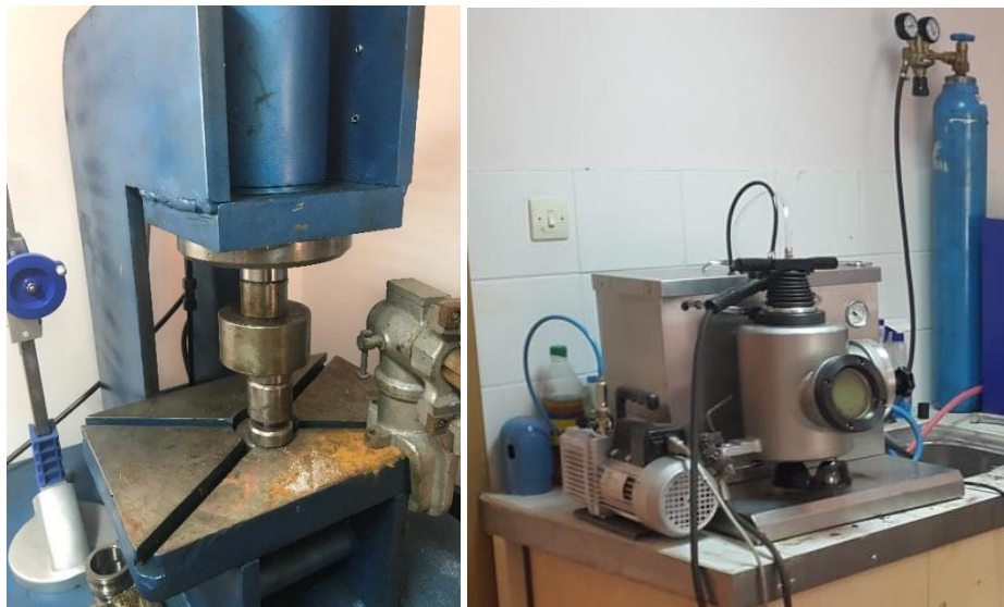
Şekil 3.3. Hidrolik pres ve ark ergitme fırın düzeneği.
