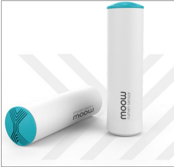
Resim 2.3. Moow işkembe içi sıcaklık, pH, CO 2 , NH 3 ölçüm ve aktarım cihazı
