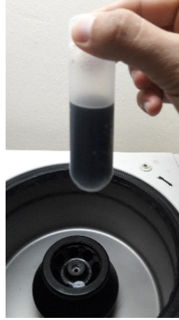
Şekil 3. 2. Isıl işlem sonrasında elde edilen karışımın santrifüj cihazına yerleştirilmesi.
