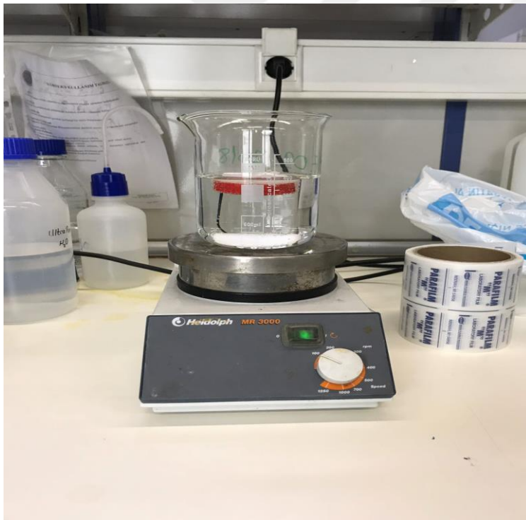
Resim 3.21. Antikorların ayrıştırılması için %0,1 NaCl çözeltisinde manyetik karıştırıcıyla gece boyu diyaliz işleminin yapılması
