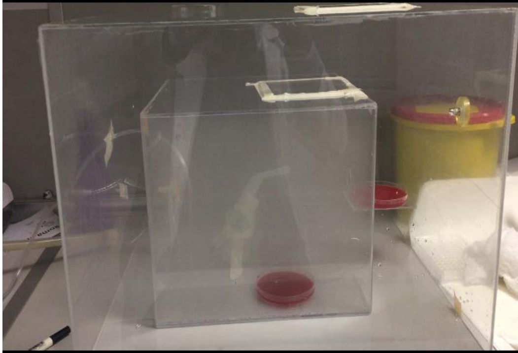
Resim 3.31. Kabinde nebulizatör ile bakterilerin püskürtme işlemi
