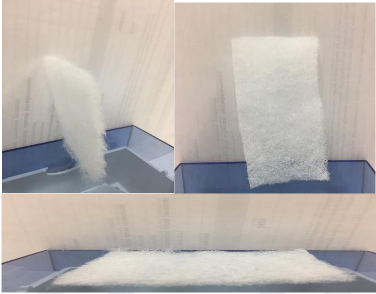
Resim 3.22. Kullanılan cam elyaf filtresi
