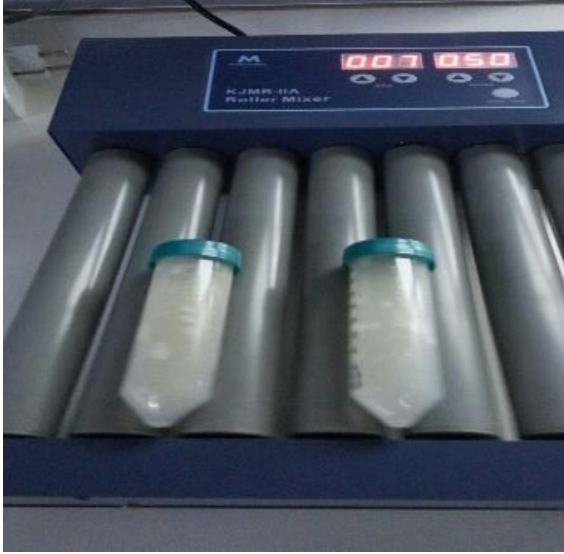
Resim 3.18. Örneklerin dönen silindir mikserde (Thermo, ABD) karıştırılması
