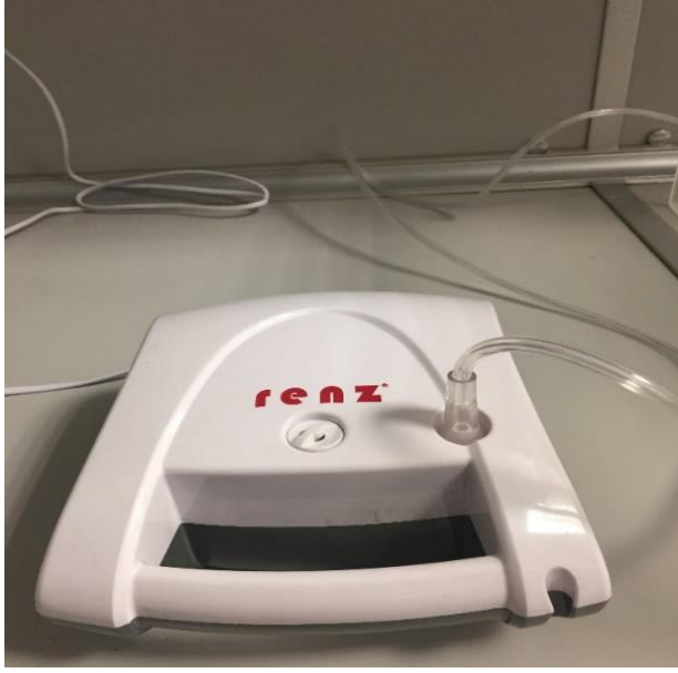
Resim 3.30. Bakteri püskürtülmesi için kullanılan nebulizatör cihazı
