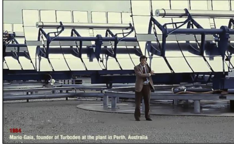
Şekil 1.18. 35 kW ORC'ye kızgın yağ sağlayan konsantre güneş kollektörleri, 1984
