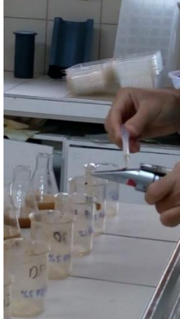
Şekil 3.12. Refraktometre ile Suda Çözünür Kuru Madde Ölçümü.
