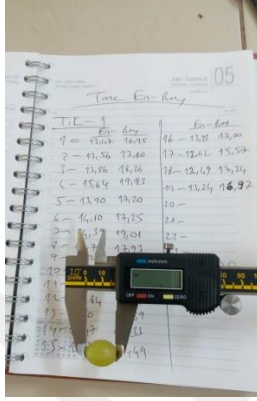
Şekil 3.11. Kumpas Yardımı ile Tane En – Boy Ölçümü.
