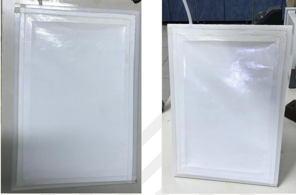
Şekil 3.4: MBR Sisteminde Kullanılan Çift Taraflı Membran Kasetleri
