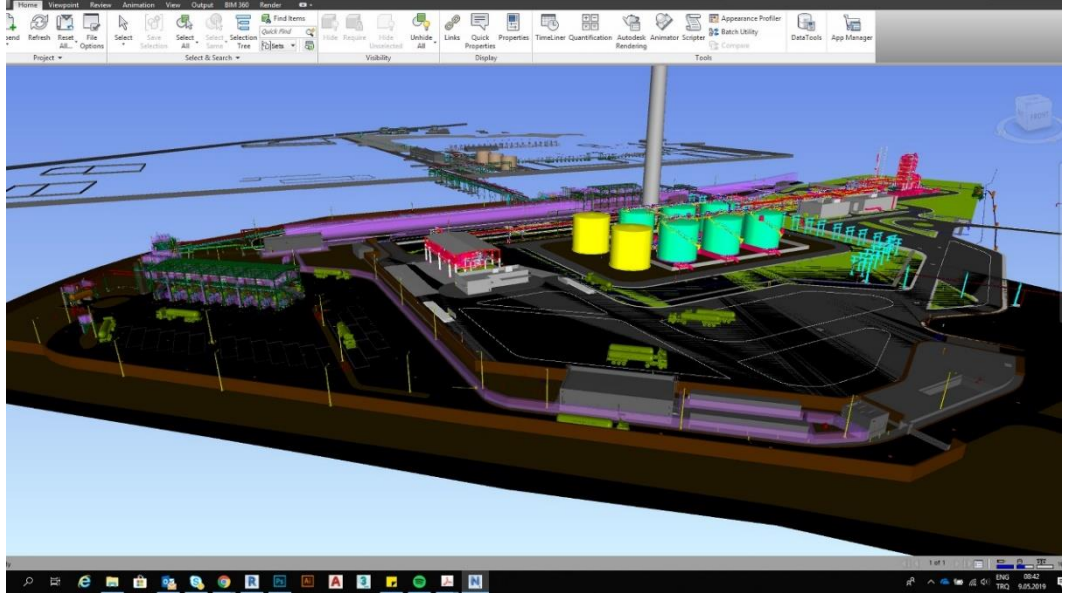
Şekil 4.6 : Doğalgaz dolum tesisi birleştirilmiş Navisworks modeli.
