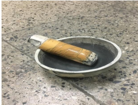
Şekil 4.1 : Al_2Cu peletlerini toz haline getirmek için kullanılan havan.
