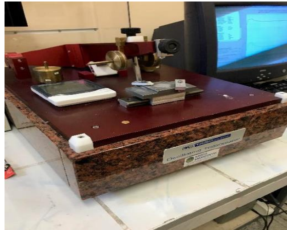
Şekil 4.4 : Çalışmada kullanılan karşıt hareketli Tribotech aşınma cihazı.
