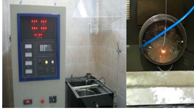
Şekil 4.3 : MAO ünitesi ve işlem sırasında numune yüzeyinde oluşan mikro-arklar.
