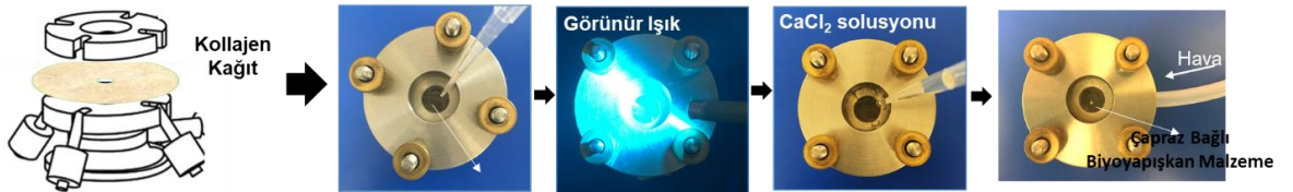
Şekil 4.26 : GelMA'dan (%20 w/v) ve değişen konsantrasyonlarda AlgMA'dan oluşan hibrid hidrojel için patlama basıncı testi hazırlık aşamaları.
