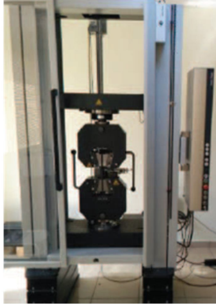
Şekil 3.2: Eksenel çekme test düzeneği.
