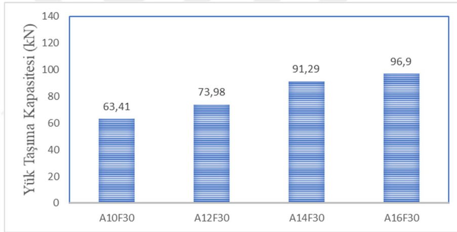
Şekil 3.10: A grubu kirişlerin yük taşıma kapasiteleri.
