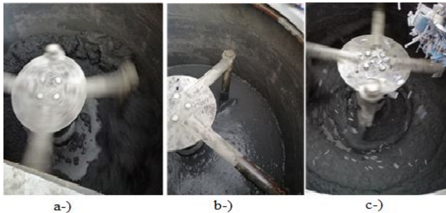
Şekil 2.8: Beton üretimi, a-)Topaklanma, b-)Akışkan kıvam, c-)Liflerin eklenmesi .
