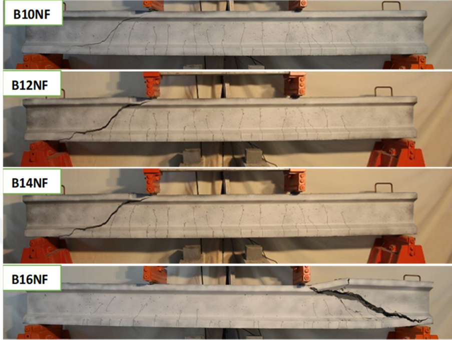
Şekil 4.19: B grubu NF kirişlere ait kırılma şekilleri.
