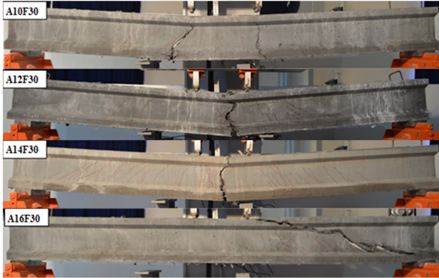
Şekil 4.8: A grubu 30 mm makro lifli kirişlere ait kırılma şekilleri.
