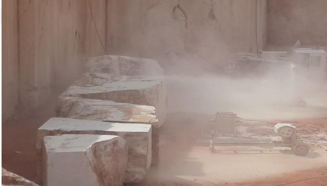
Şekil 2.5. Mermer bloklarının kesimi ve kullanılan ekipmanlar
