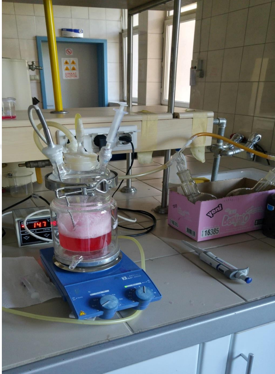
Ozon ile arıtım yönteminde pH 7’de deney düzeneđi-köpük oluşumu
