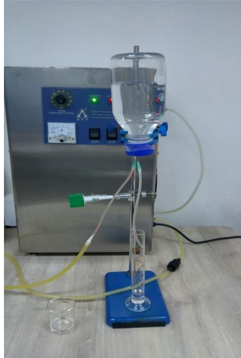
Ozon jeneratörünün debisinin belirlenmesi için deney düzeneği
