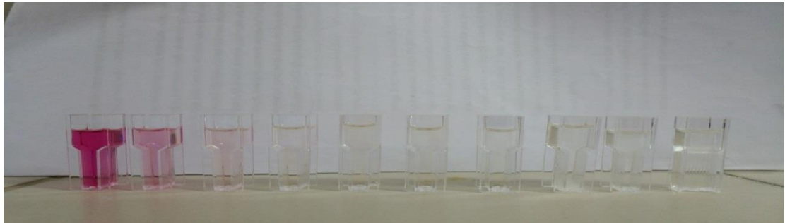
pH:12.24'te ozon ile arıtım yönteminde zamanla renk giderimi (90 dakika)
