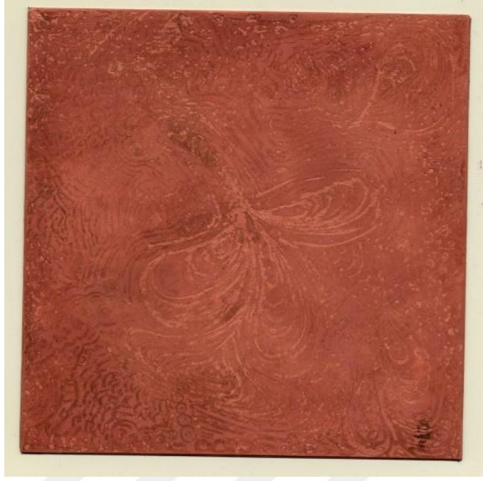
Şekil 5.10. Kumaşın Plakaya Bastırılması.
