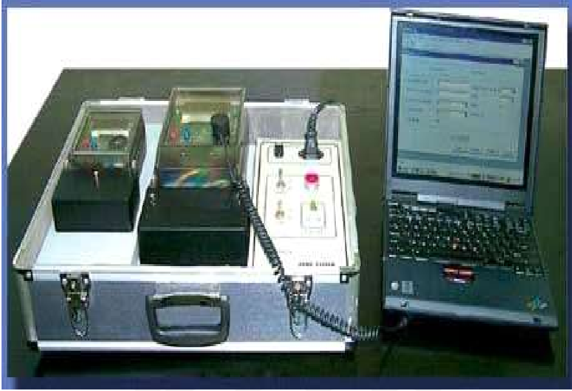
Resim 4.2. Sayaçların PC aracılığıyla optik porttan okunması (Aydın, ve diğerleri, 2008)
