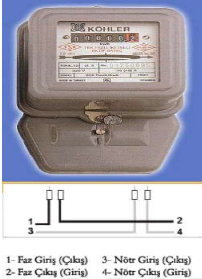
Şekil 4.1. Tek fazlı mekanik aktif sayaç ve bağlantı biçimi (Hungwu ve diğerleri, 2004)
