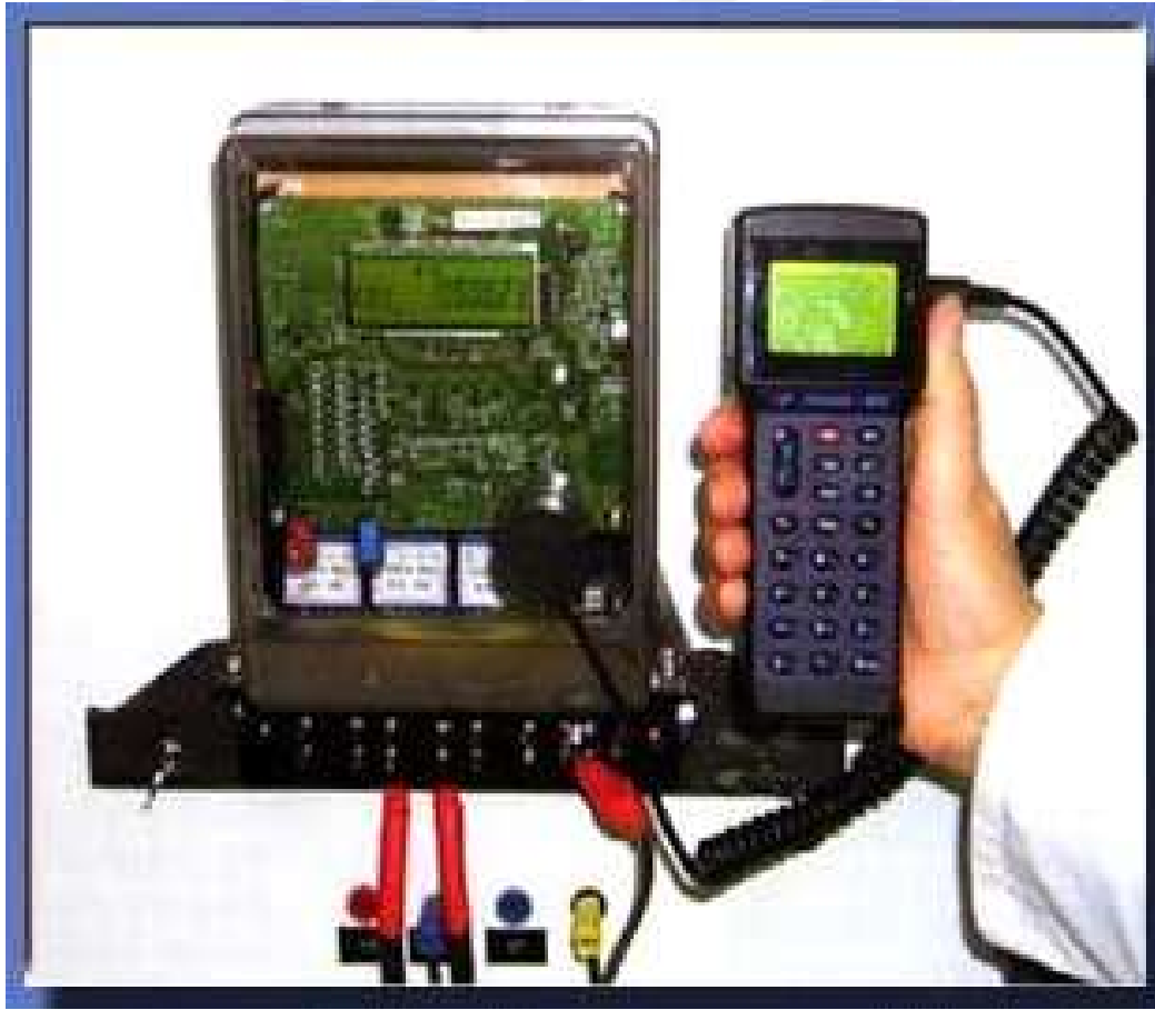
Resim 4.1. Sayaçların el terminali ile optik porttan okunması (UGATEM A.Ş., 2019)
