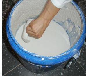
Resim 3.11: Seramik-Çini Bünyenin Daldırma Yöntemiyle Sırlanması ve Fırın Plakasına Değen Yerlerin Sırının Silinmesi
