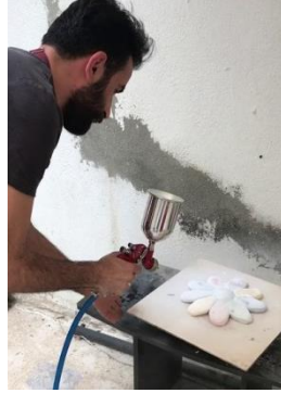
Resim 3.12: Seramik-Çini Bünyenin Püskürtme Yöntemiyle Sırlanması
