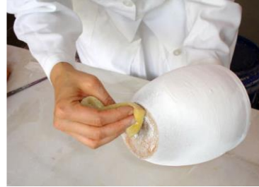
Resim 3.11: Seramik-Çini Bünyenin Daldırma Yöntemiyle Sırlanması ve Fırın Plakasına Değen Yerlerin Sırının Silinmesi
