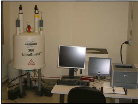
Şekil 3.3. 300 MHz işletim frekanslı sıvı Bruker 300 MHz AV model NMR spektrometresi
