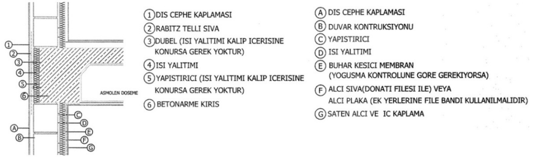
Şekil 2.3 : İçten ısı yalıtım uygulaması (Binalarda Isı Yalıtım Yönetmeliği, 2008).
