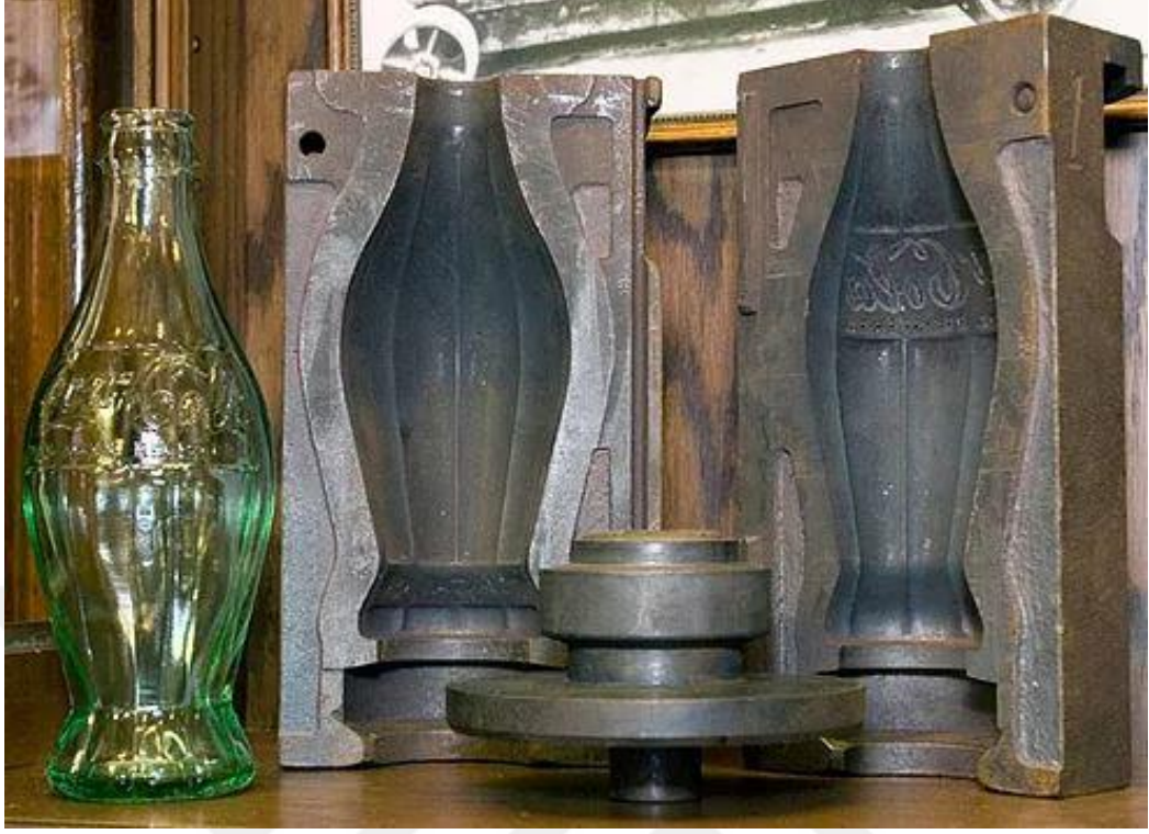
Şekil 9: Patenti Alınan Coca-Cola Cam Şişe Kalıbı Ve Üretilen Cam Şişe
