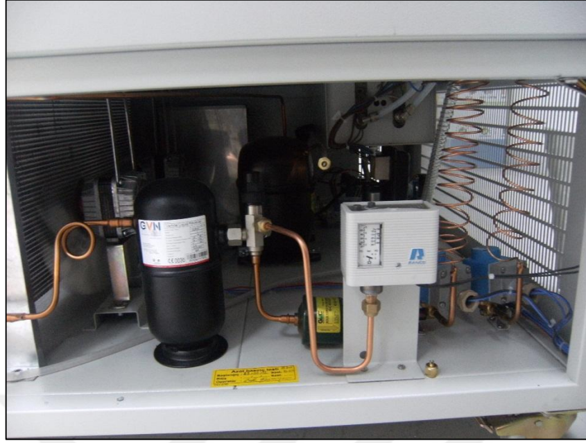
Şekil 3.2. TK 120 cihazı soğutma sistemi
