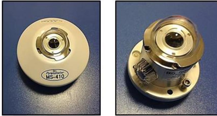
Şekil 2.12: MS-410 First class pyranometer ve iç kısmı.
