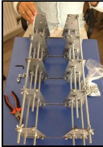
Şekil 2.10: Çekmece kalıbının montaj işlemi.
