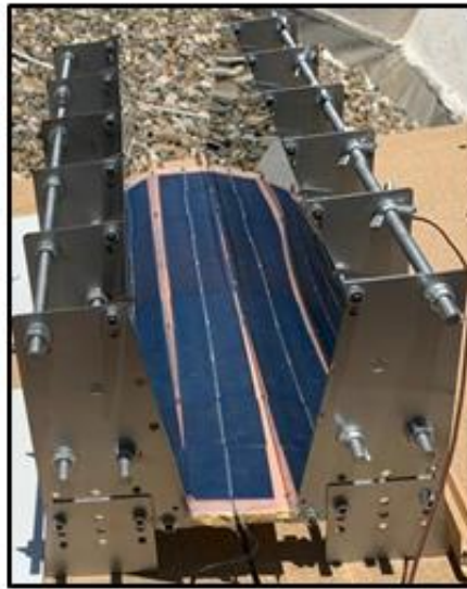
Şekil 2.11: V-oluk-PV sisteminin montajı.
