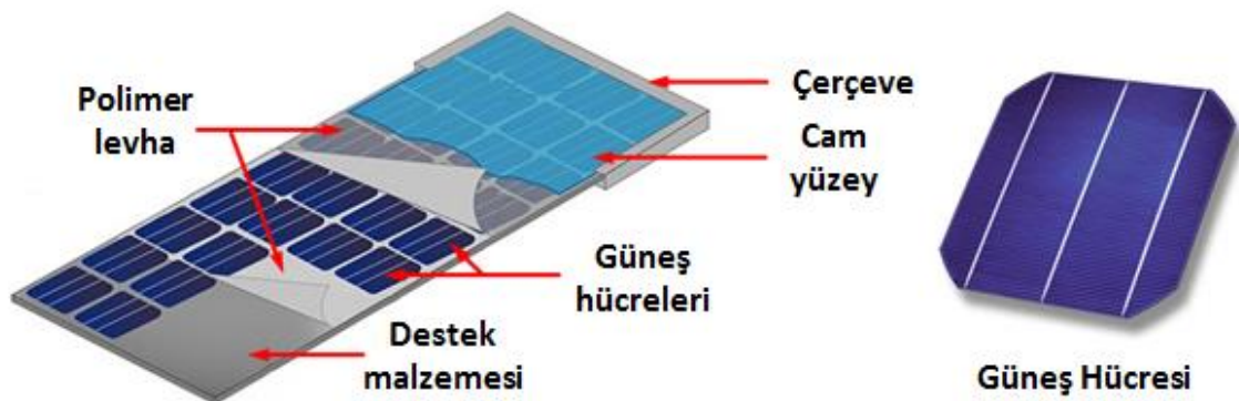
Şekil 1.14: Güneş hücresinin yapısı (URL-17, 2017).
