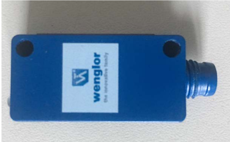
Şekil 4.1. "lightsensor.txt" ölçüm nesnesi fiziksel yapısı
