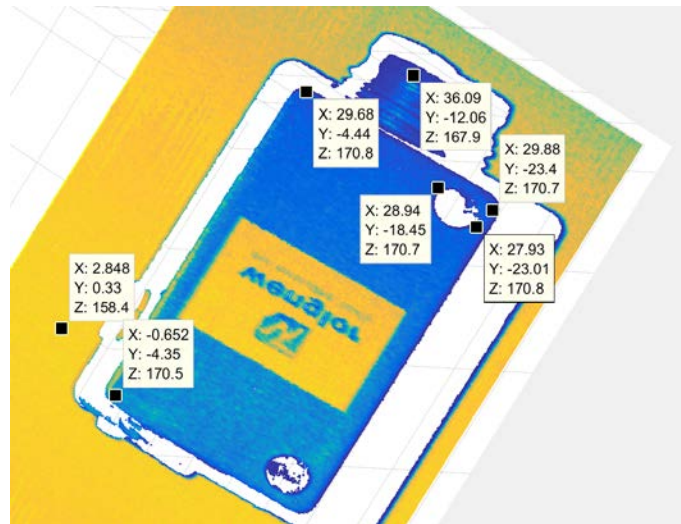
Şekil 4.4. "sensor.txt" nokta bulutu noktasal değer örnekleri
