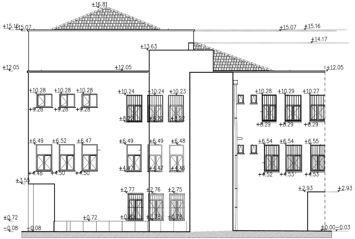
Şekil 4.27: İncelenen yapının batı cephesi rölöve planı
