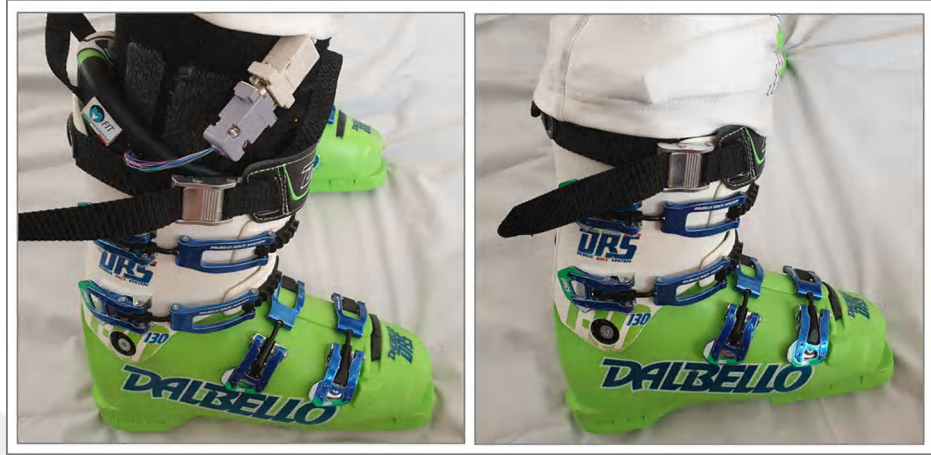
Şekil 19. Kayak ayakkabısına yerleştirilen basınç tabanlıklardan gelen kabloların kayak ayakkabısı üzerindeki bağlantı noktası ve yerleşimi
