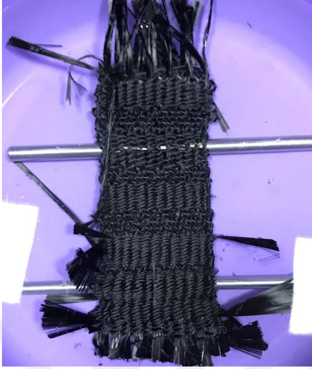
Şekil 3.19 Sıcak suda bekletilerek PVA hasılı uzaklaştırılan el dokuma karbon kumaş.
