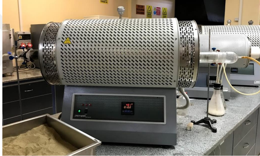
Şekil 3.29 Nitinol tel ve nitinol tel özlü hibrit ipliklere ısıt işlemin uygulandığı tüp fırın.
