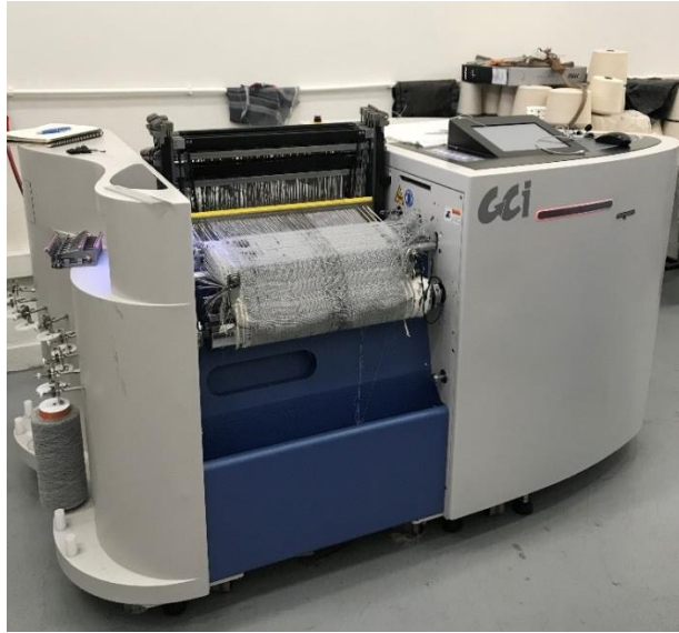
Şekil 3.16 Kumaş üretimlerinin gerçekleştirildiği otomatik numune karbon dokuma makinesi.
