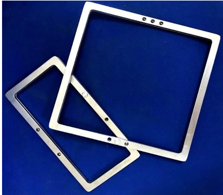
Şekil 3.2 Isıt işlemlerde kullanılan numune tutucu çerçeveler.
