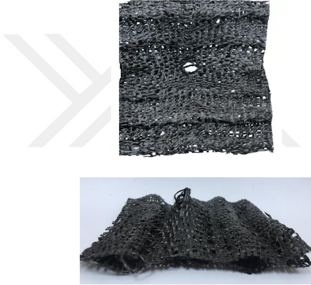
Şekil 3.38 Darbe kuvveti ile delinmiş bir numunenin önden ve yandan görünümü.
