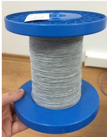
Şekil 3.9 PVA iplik ile sarılmış bükümlü karbon elyaf iplik.
