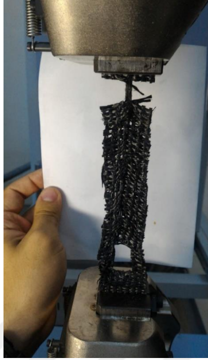
Şekil 3.36 Kayma direnci testi sırasında çenelere tutturulmuş numunenin görünümü.
