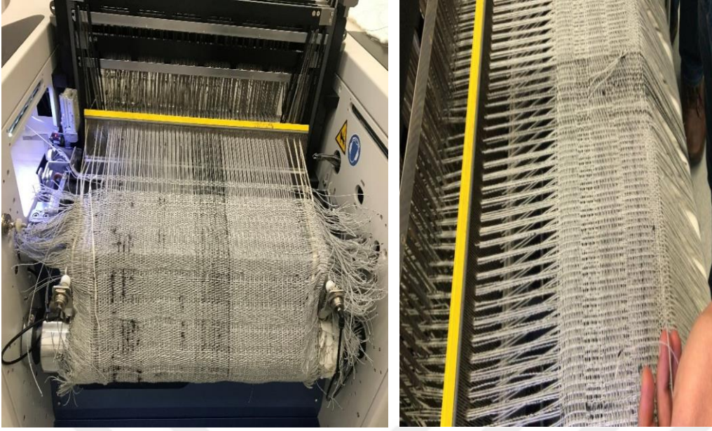
Şekil 3.17 Üç boyutlu dokuma kumaşın üretimi.
