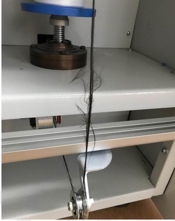
Şekil 3.5 Hibrit iplik üretimi esnasında karşılaşılan iplik hataları.
