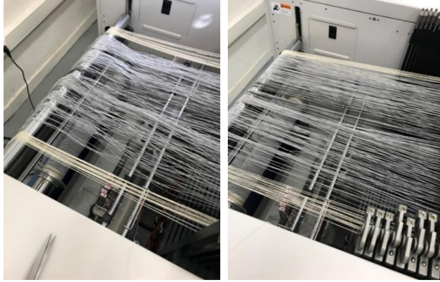
Şekil 3.18 Leventten salınan çözgü ipliklerinin görünümü.
