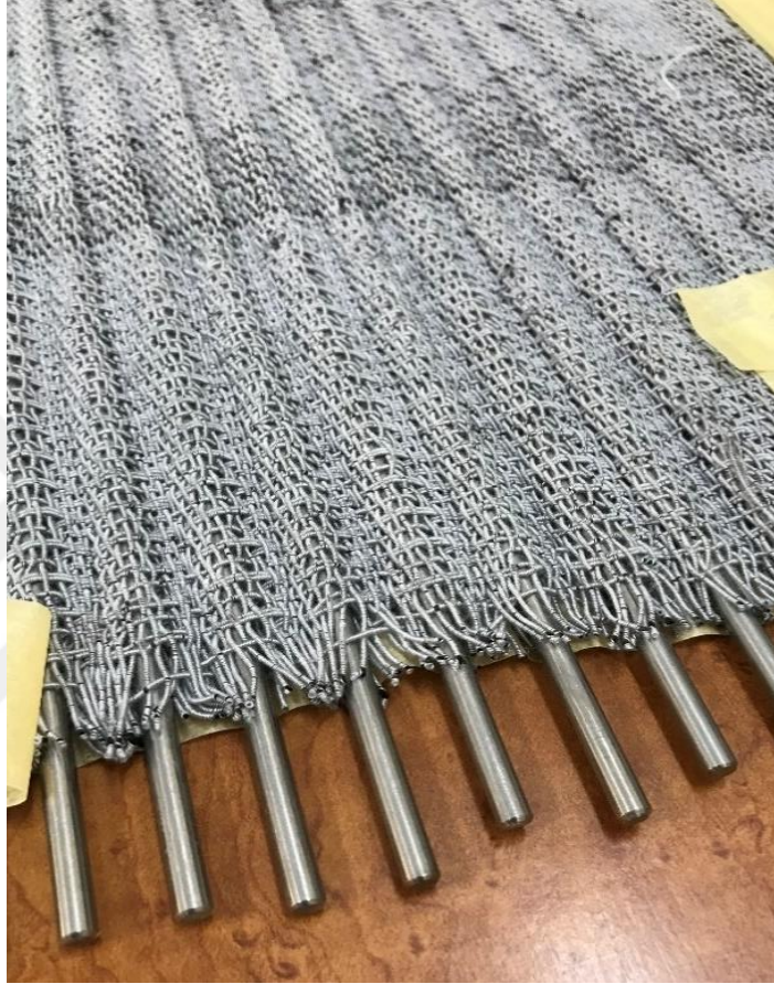
Şekil 3.21 Kumaş boşluklarına yerleştirilen çelik çubuklar.
