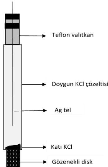
Şekil 3. 10. Gümüş-gümüş klorür referans elektrot (Alanyalıoğlu, 2006)
