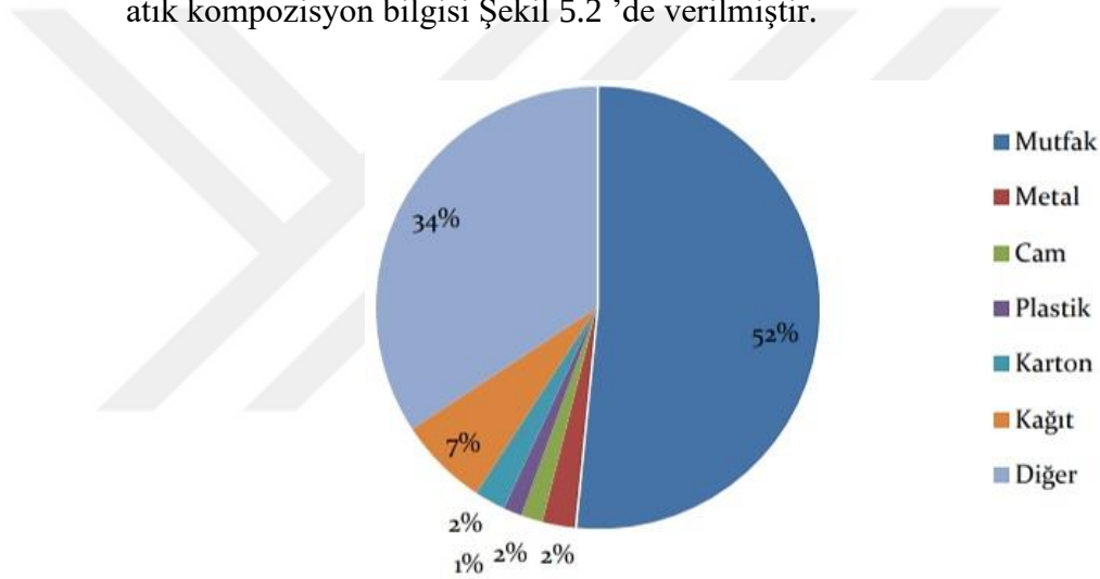
Şekil 5.2 Örnek tesise ait 2018 yılı atık kompozisyonu
