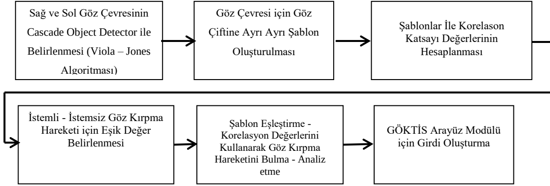
Şekil 2.3. Göz kırpma hareketi için görüntü işleme adımları
