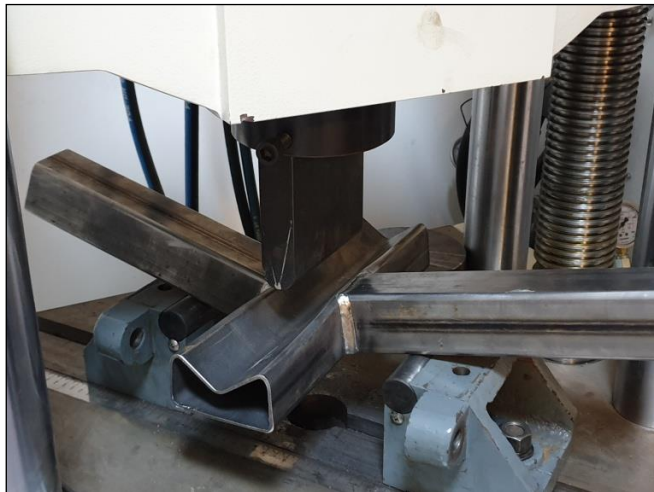
Şekil 4.7. Üç nokta eğilme testi sonucunda eğilmiş durumdaki çelik profil numune
