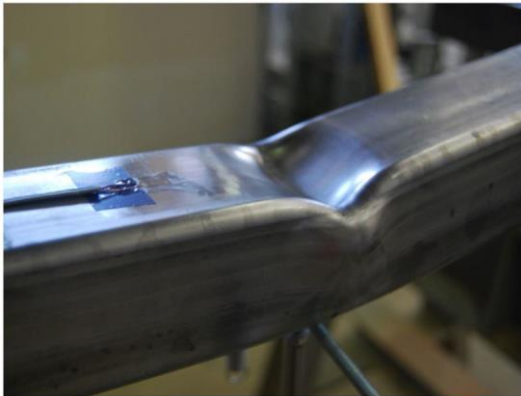
Şekil 2.14. “Üç nokta eğilme testi” sonucu plastik deformasyona uğramış içi boş dikdörtgen kesitli numunenin görünümü [15]
