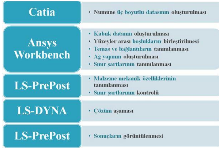
Şekil 5.1. Üç nokta eğilme testine ait nümerik modelleme ve analiz aşamaları (ANSYS sonlu elemanlar kodu ile çözüm basamakları)
