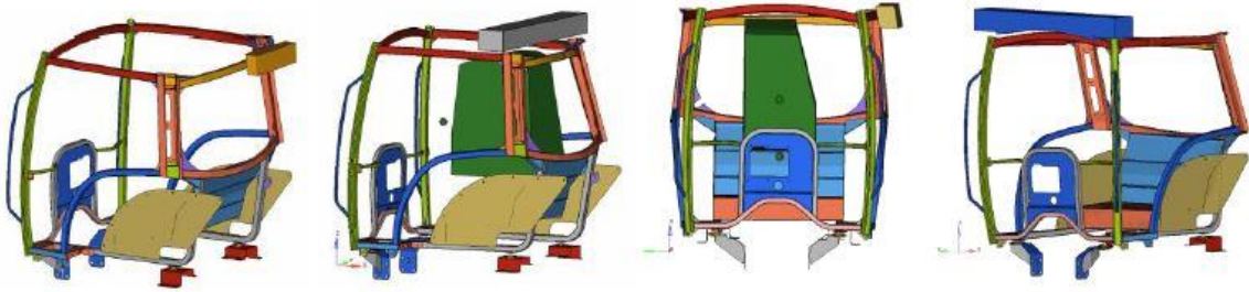
Şekil 2.4. Devrilme testlerinin uygulanma sıralaması – boylamasına, arka üst, yanal, ön üst yüklemeler [7]
