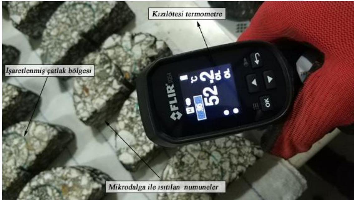
Resim 3.17. Mikrodalga ile ısıtılan numunelerin sıcaklığının kızılötesi termometre ile ölçümü
