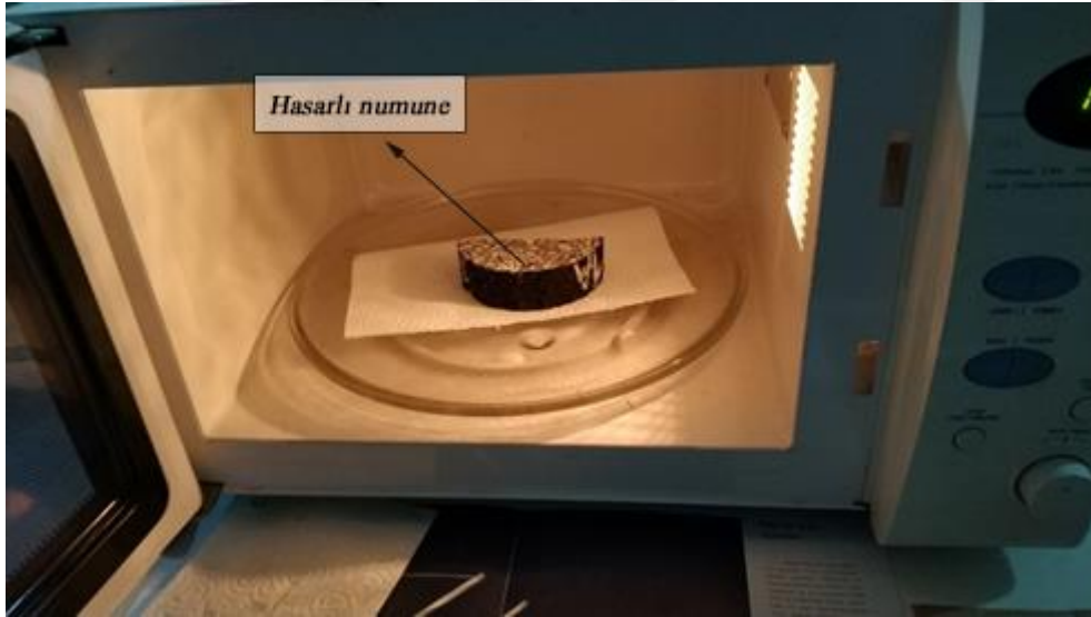
Resim 3.16. Numunelerin mikrodalga ısıtması ile iyileştirilmesi işlemi
