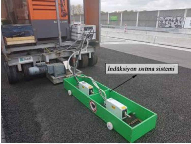
Resim 2.14. HEALROAD projesinde yol yüzeyine indüksiyon ısıtması uygulanması [97]
