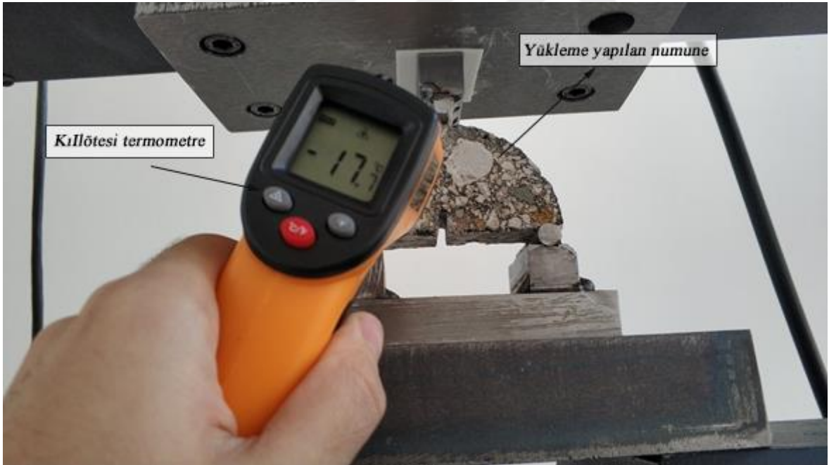
Resim 3.15. Numune yüklenirken sıcaklığının kontrol edilme işlemi
