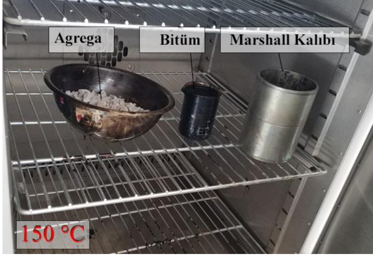
Resim 3.2. Agrega, bitüm ve Marshall kalıbının etüvde ısıtılması
