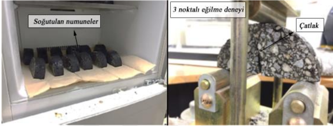
Resim 2.16. Numunelerin -18 °C 'ye soğutulması ve 3 noktalı eğilme deneyi [25]
