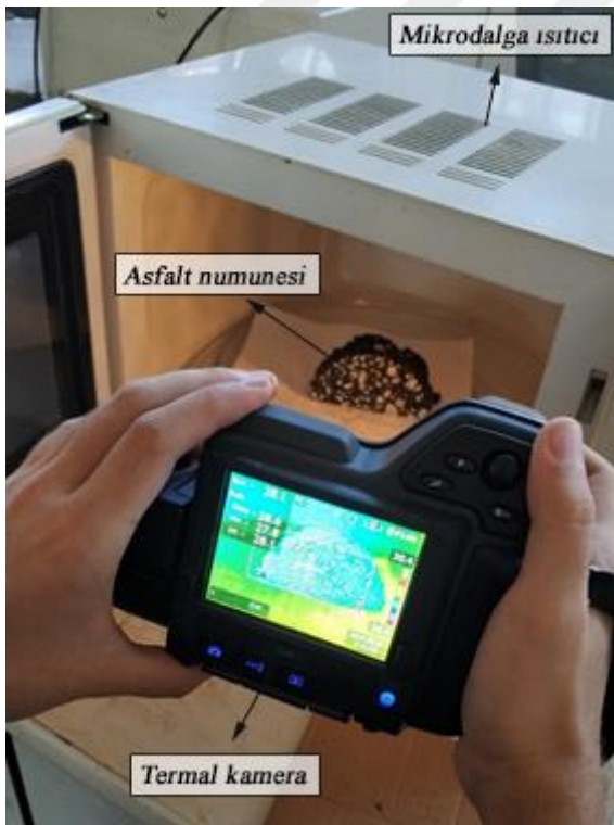
Resim 3.8. Numunenin termal kamera ile görüntülenmesi işlemi
