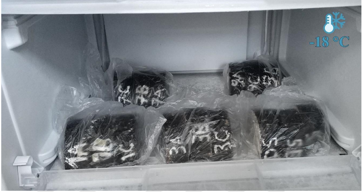
Resim 3.14. Numunelerin derin dondurucuda soğutma işlemi
