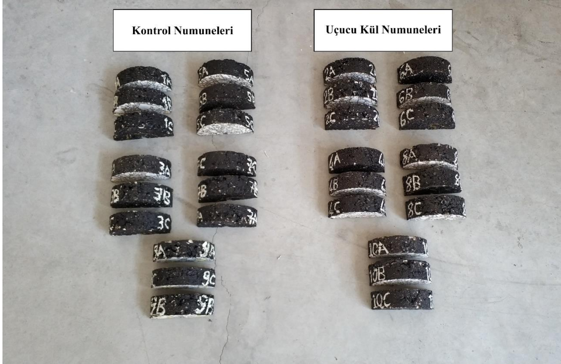
Resim 3 6. Deneyde kullanılan kontrol ve uçucu kül (UK) numuneleri
