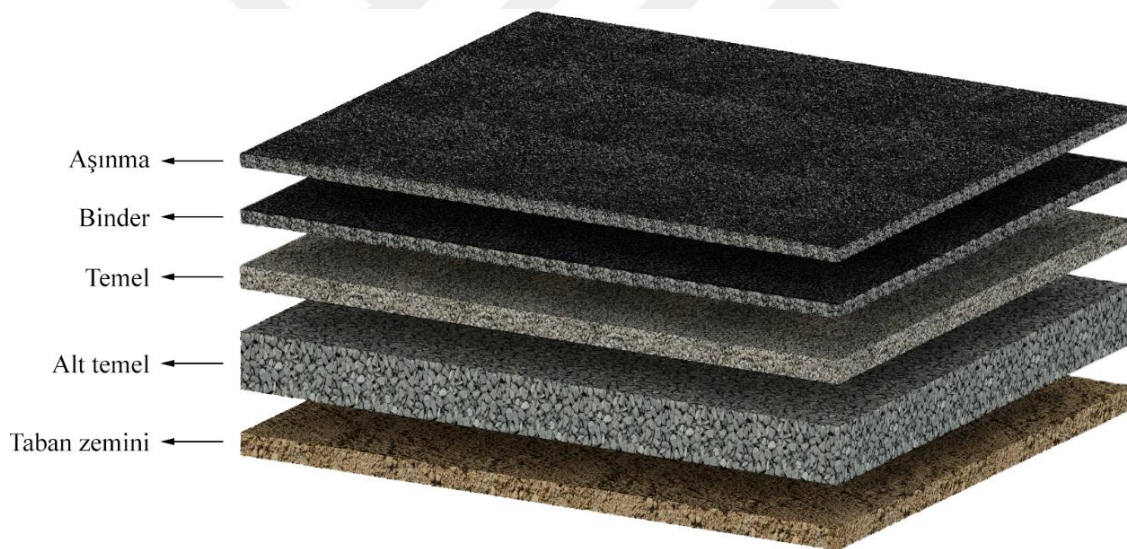
Resim 2.1. Tipik bir esnek kaplamayı oluşturan tabakalar
