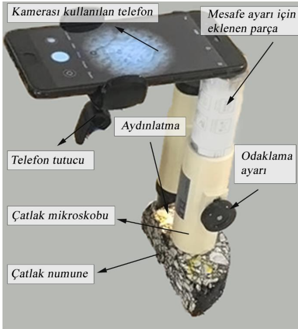
Resim 3.18. Çatlak mikroskobu ile kurulan fotoğraflama düzeneği
