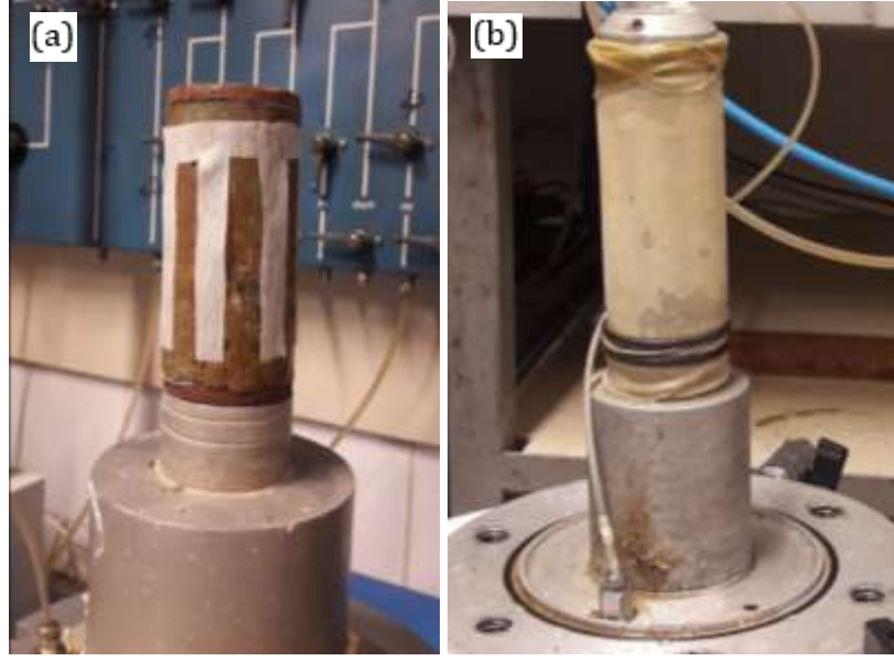
Şekil 3.13 CU deney numunesinin hazırlanması (a) Poroz disk, filtre kağıdı ve yanal filtre bandının yerleştirilmesi (b) Lastik kılıfın yerleştirilmesi
