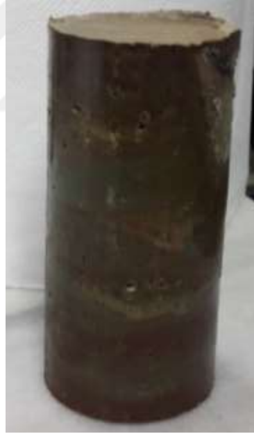
Şekil 3.12 Sondaj kesitinden alınan CU deney numunesi
