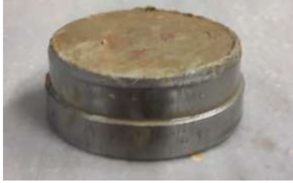
Şekil 3.18 Konsolidasyon halkasına yerleştirilmiş numune
