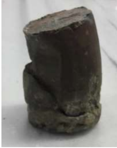
Şekil 3.16 Deney sonunda numunede gözlenen göçme yüzeyi
