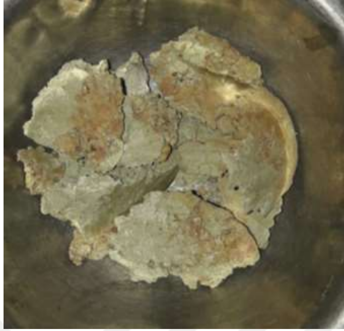
Şekil 3.6 Doğal su muhtevası ölçümü için sondaj kesitinden alınan numune örneği
