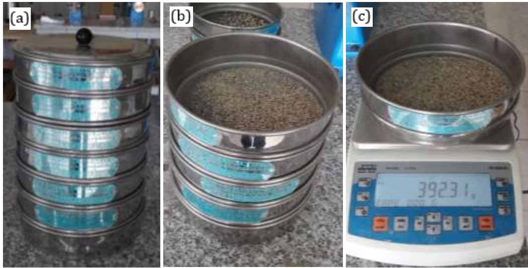
Şekil 3.2 Kuru numune üzerinde elek analizi (a) Elek seti (b) Elek üzerinde kalan numune (c) Elek üzerinde kalan numune miktarının ölçümü
