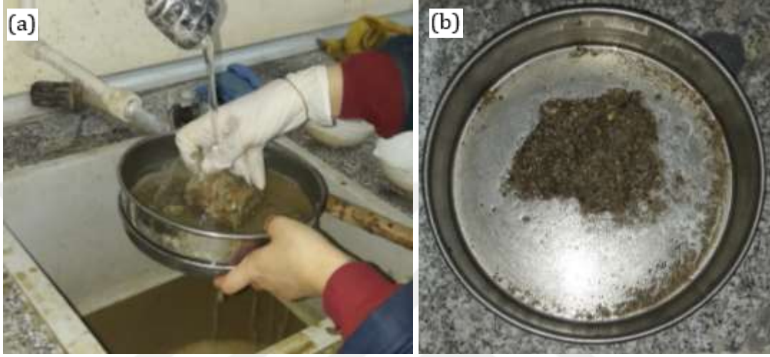
Şekil 3.1 Yıkamalı eleme metodu (a) 200 No’lu elek üzerinden numuneye uygulanan yıkama işlemi (b) Yıkama işleminde elek üzerinde kalan numune
