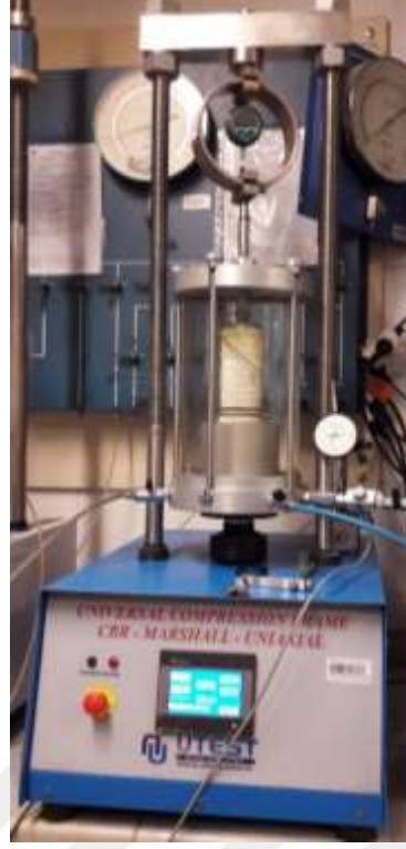
Şekil 3.14 Numunenin üç eksenli deney aletine yerleştirilmesi
