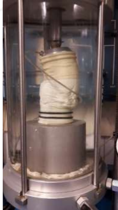
Şekil 3.15 Numunenin deney sırasında gözlenen göçme durumu
