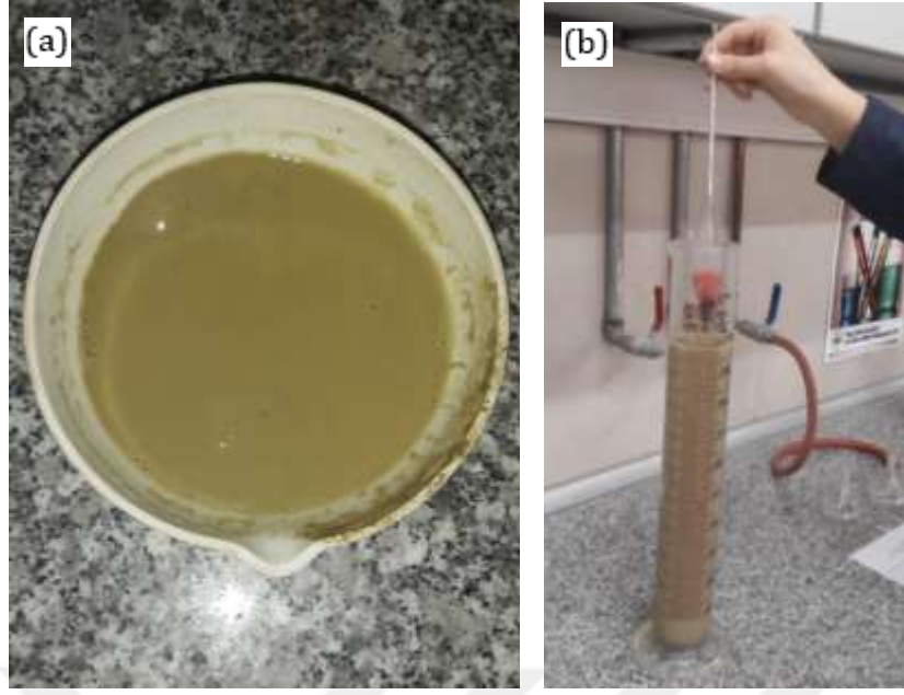
Şekil 3.3 Hidrometre deneyi (a) Çözeltide bekletilen numune (b) Numunenin hidrometre okumasının alınması
