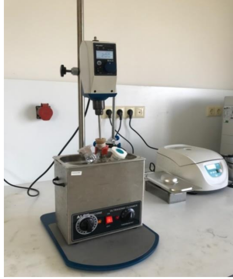
Şekil 3.5. PBI membran hazırlamak için kullanılan deney düzeneği
