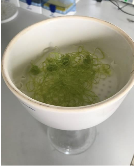
a. Filtre edilerek Deiyonize su ile yıkanma işlemi
