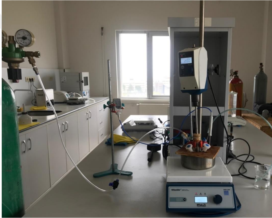
Şekil 3.1. PBI sentezinin gerçekleştirildiği reaktör sistemi
