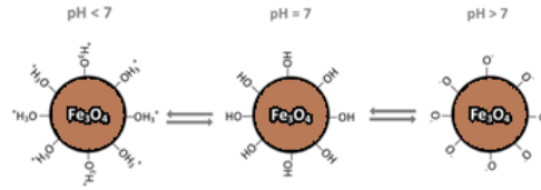
Şekil 2.9 Değişik pH'larda \text{Fe}_3\text{O}_4 'ün davranışı
