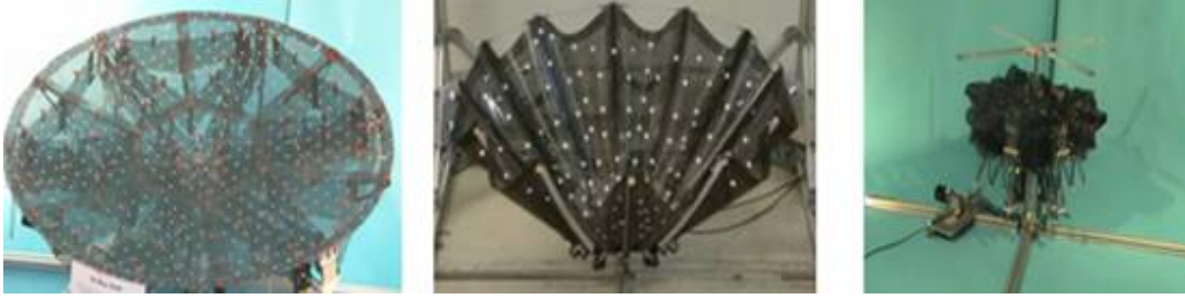
Şekil 1.1 Datashvili vd. (2005) tarafından geliştirilmiş silikon matrisli karbon fiber reflektör, (a: reflektörün açılmış hali, b: reflektörün şemsiye tipinde paketlenmesi c: reflektörün rastlantısal paketlenmesi).
