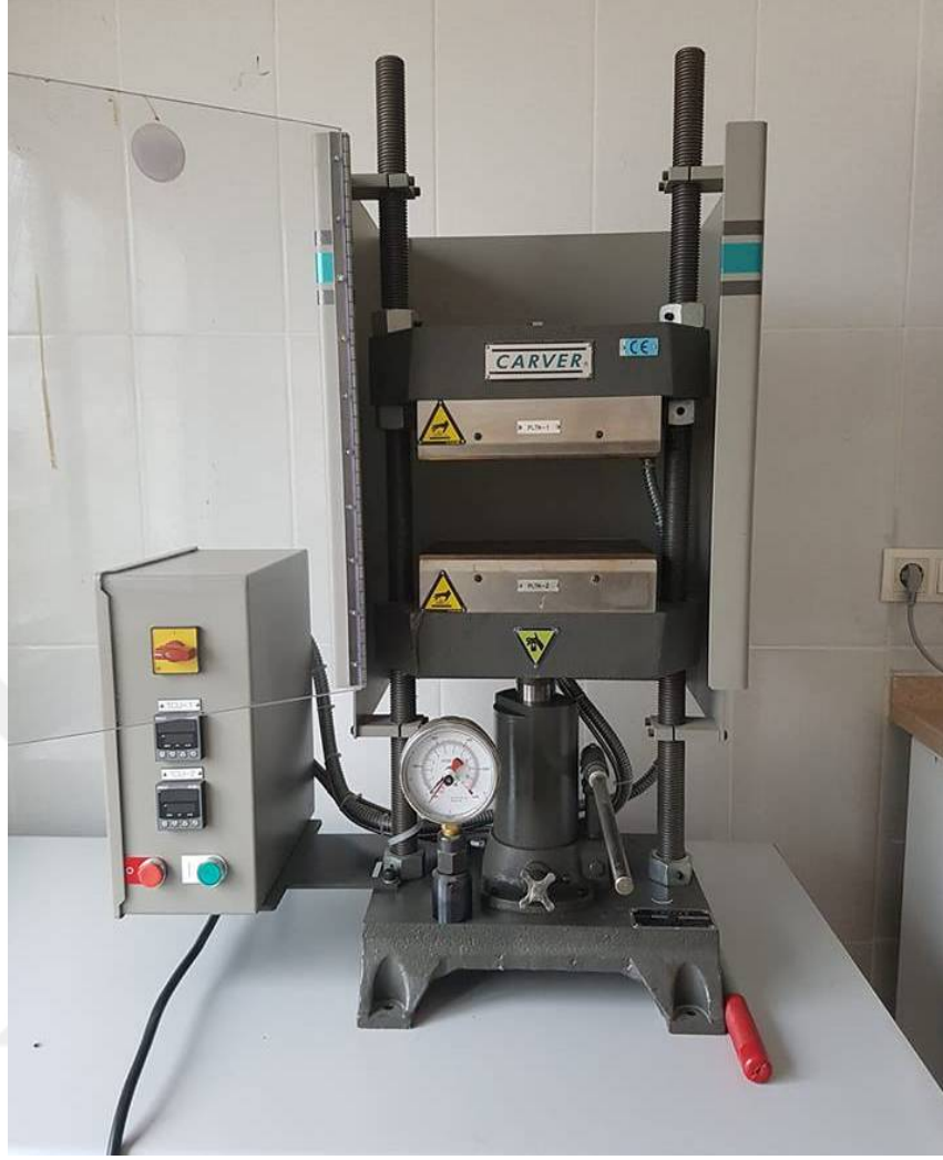
Şekil 3.5 Kompozit malzeme üretiminde kullanılan sıcak pres cihazı.
