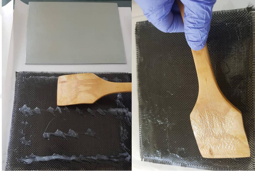
Şekil 3.9 Kompozit numunelerin hazırlanmasında silikonun uygulama aşaması.
