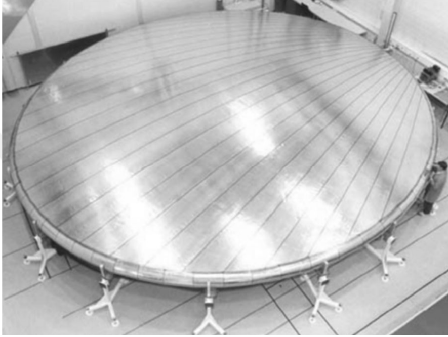
Şekil 2.9 Contraves Uzay Birimi’nde geliştirilen şişirme-rijitleme yöntemi ile kapanıp açılabilen reflektör anten (Cassapakis and Thomas 1995).
