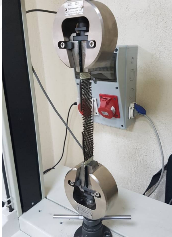
Şekil 3.7 Kumaş numuneler için kullanılan çekme test düzeneği.
