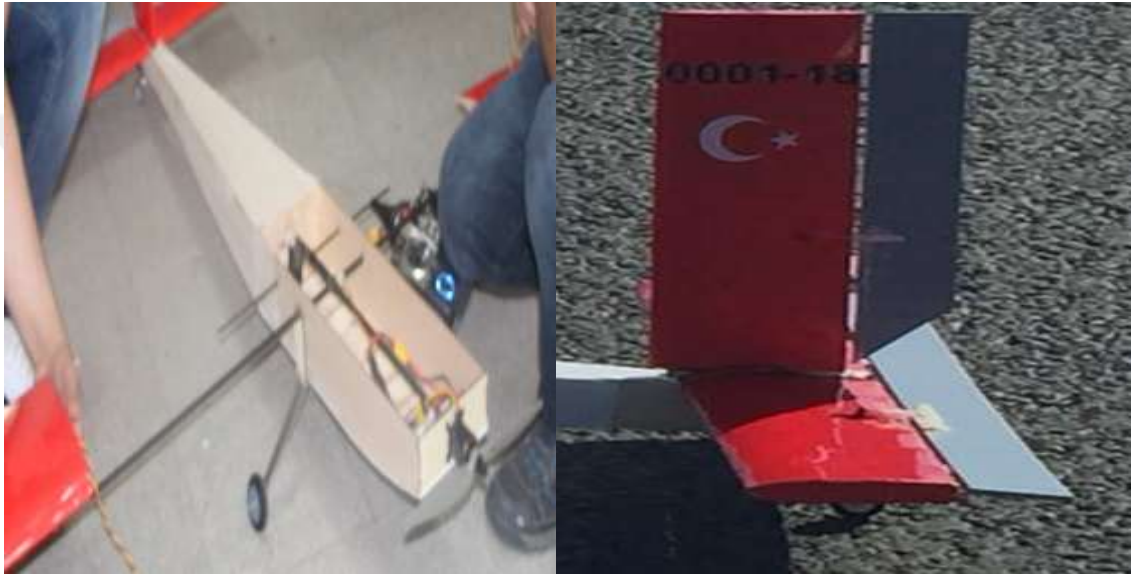
Şekil 3.15. Kuyruk ve Motor İmalatı
