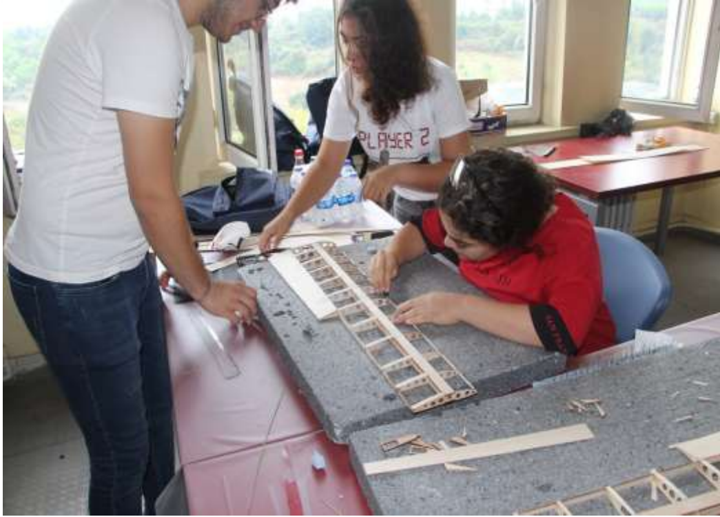
Şekil 3.24. İHA Kanat Profili Yapımı
