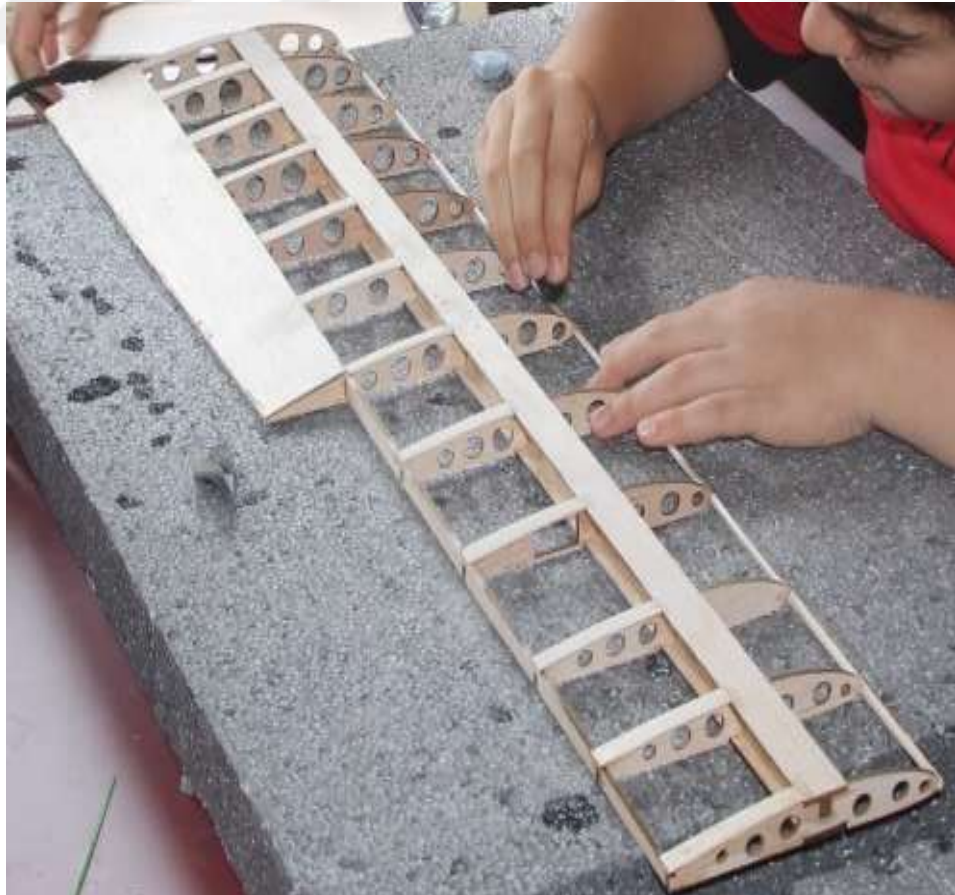
Şekil 3.14. Kanat Profili İmalatı
