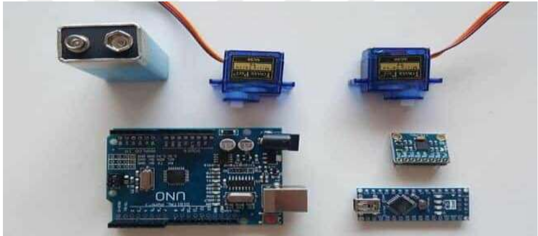
Şekil 2.2. Arduino kiti ile Gimbal Kamera kontrolü Elemanları[22]
