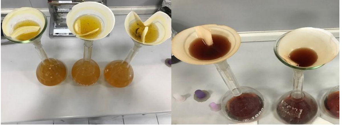
Şekil 4.4. İzopropil Alkol-Muz Kabuğu ve İzopropil Alkol-Meyan Kökü Çözeltilerinin Filtre Kağıdı Aracılığıyla Süzölmesi
