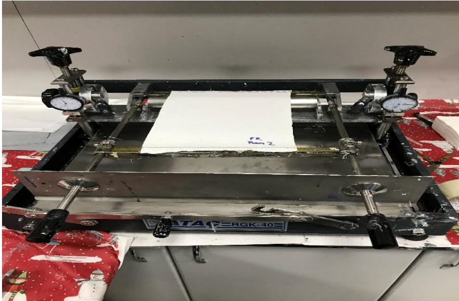
Şekil 4.7. Hazırlanan Kaplama Patlarının Kumaşlar Üzerine Uygulanması
