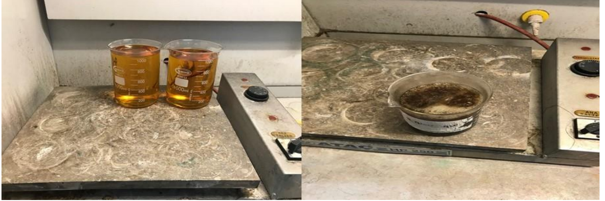
Şekil 4.5. İzopropil Alkolün Çözeltiden Uzaklaştırılma Adımı
