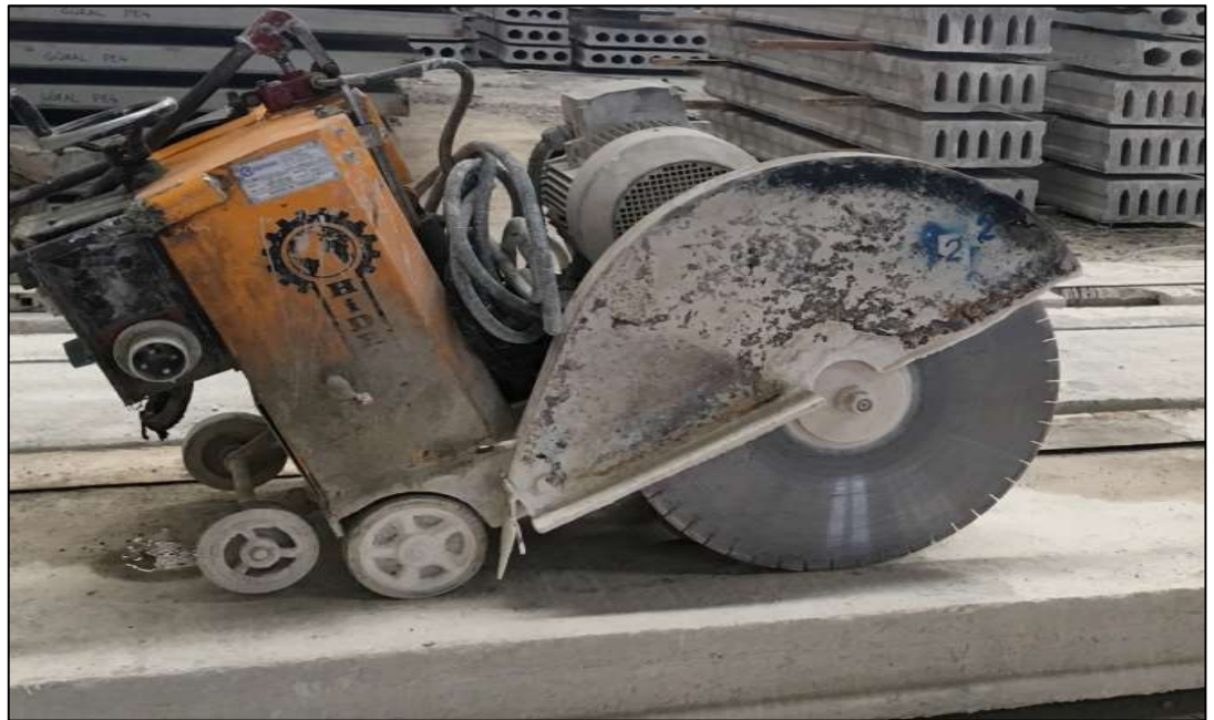
Şekil 3.11. Öngermeli boşluklu döşemenin istenen ebata göre kesilme aşaması
