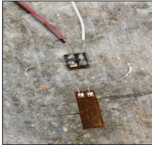
Şekil 7.4. Gerinim pulu, bağlantı terminali ve bağlantı kabloları
