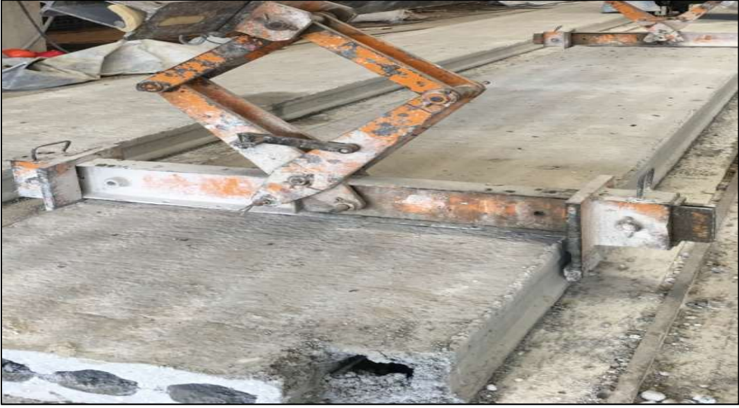
Şekil 3.12. Öngerilmeli boşluklu döşeme kaldırma aparatı
