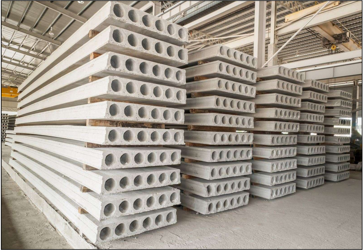
Şekil 3.13. Öngerilmeli boşluklu döşemelerin istiflenmesi (Anonim, 2012)
