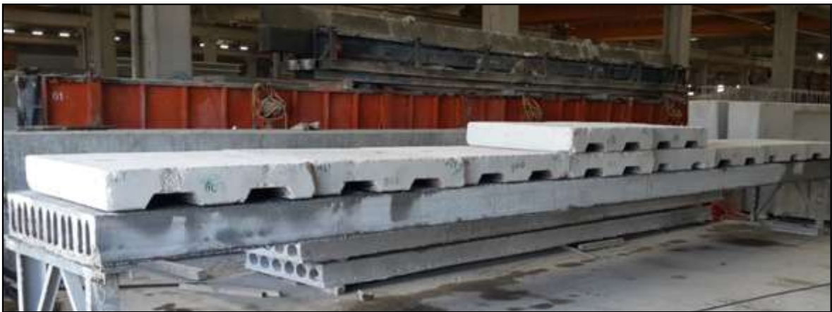
Şekil 3.15. h=24 cm L=800 cm olan öngerilmeli boşluklu döşeme yükleme deneyi
