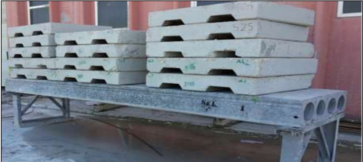
Şekil 3.14. h=20 cm L=400 cm olan öngerilmeli boşluklu döşeme yükleme deneyi
