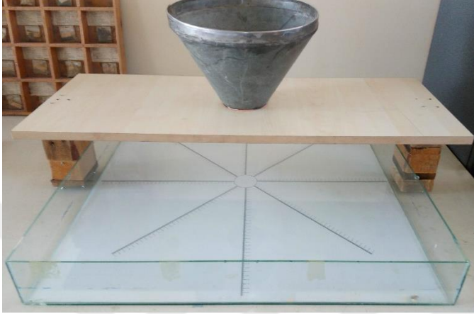
Şekil 3.2. Doğal yığılma açısı ölçüm düzeneği (Alayunt, 2000)
