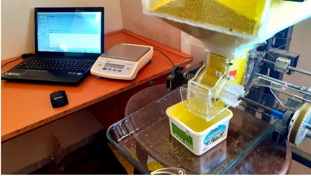
Şekil 3.12. İmal edilmiş makaralı ekici düzenin genel görünüşü
