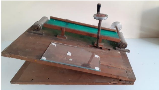
Şekil 3.1. Sürtünme katsayısı ölçüm düzeneği
